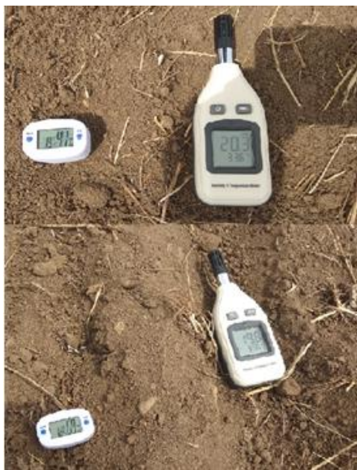
Рисунок 4.22- Измерения влажности и температуры плодородного слоя ПОЧВЫ
