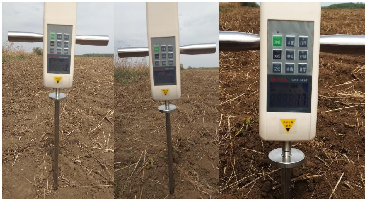
Рисунок 4.21- Измерение твёрдости почвы на поле, обработанном МТА с экспериментальным трактором
