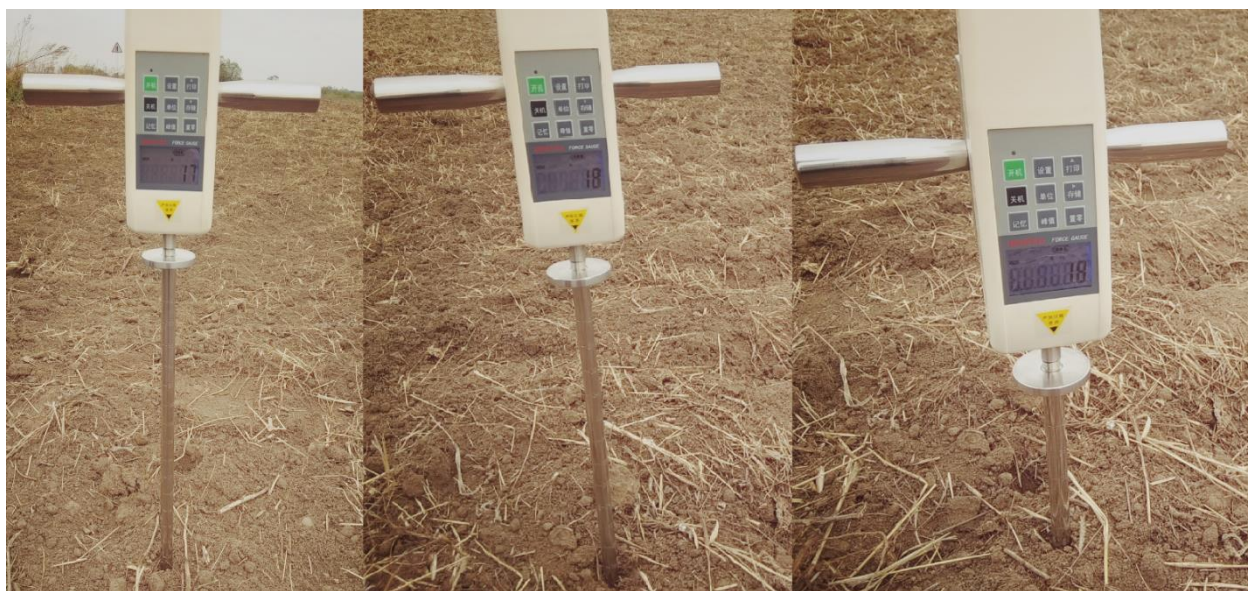
Рисунок 4.20- Измерение твёрдости почвы на поле, обработанном серийным трактором
