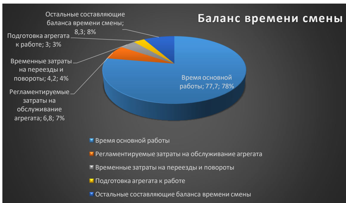
Рисунок 4.19- Распределение баланса времени смены на сплошной культивации (экспериментальный МТЗ-80 +КПС-4М)
