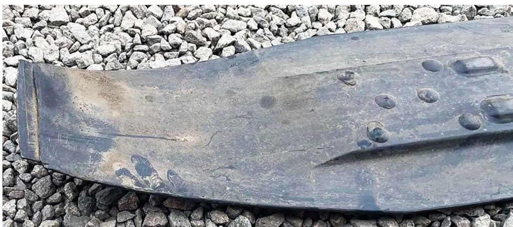
Рисунок 1 – Неисправная направляющая жатки CLAAS Maxflex 930
