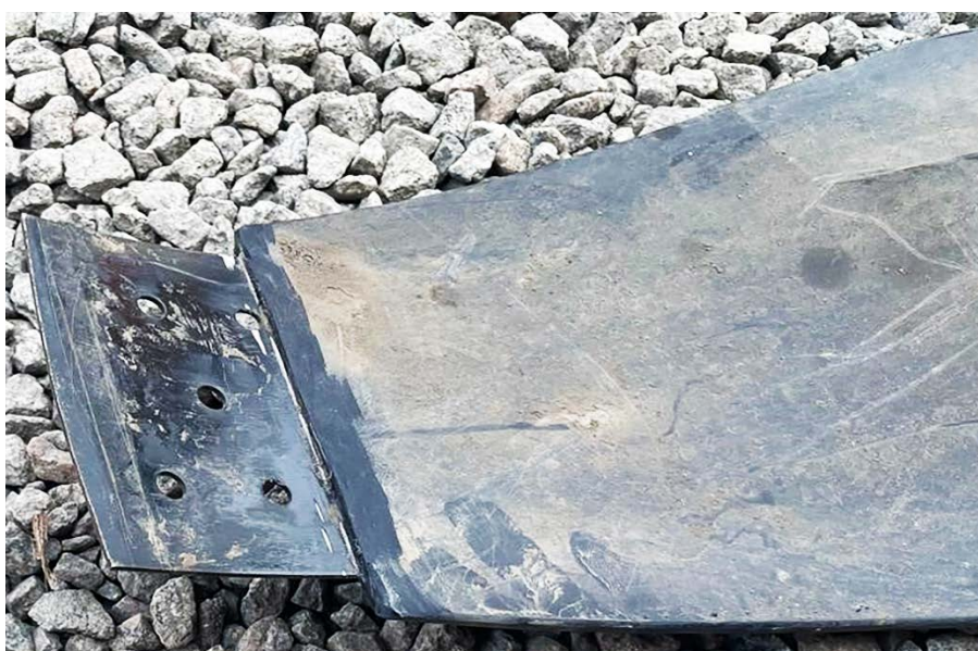
Рисунок 3 – Направляющая, подготовленная к установке пластины
