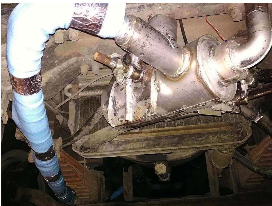
Рисунок 1 – Усовершенствованный предпусковой подогреватель с изоляцией металлизированного гофрированного рукава на автомобиле
