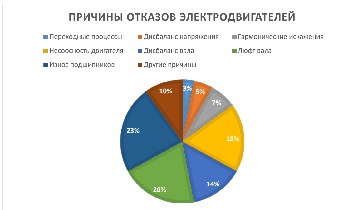
Рисунок – Структура причин выхода из строя электродвигателей
