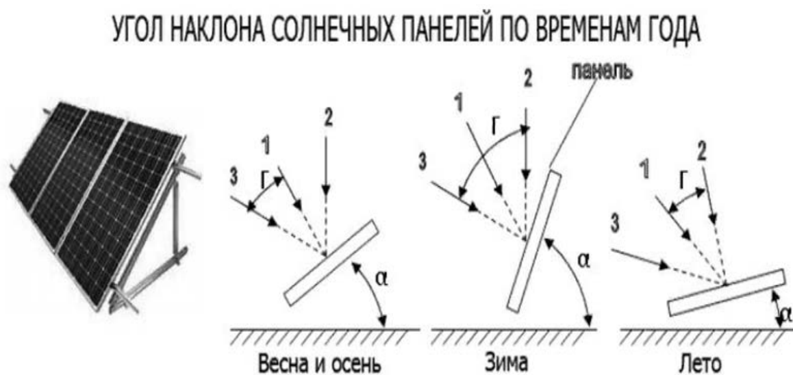
Рисунок 2 – Определение угла наклона солнечного коллектора
