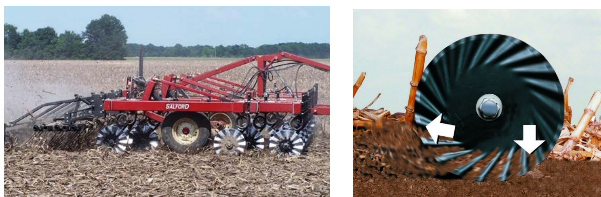
а – общий вид; б – принцип работы турбодиска Рисунок 7 – Орудие вертикальной обработки почвы
