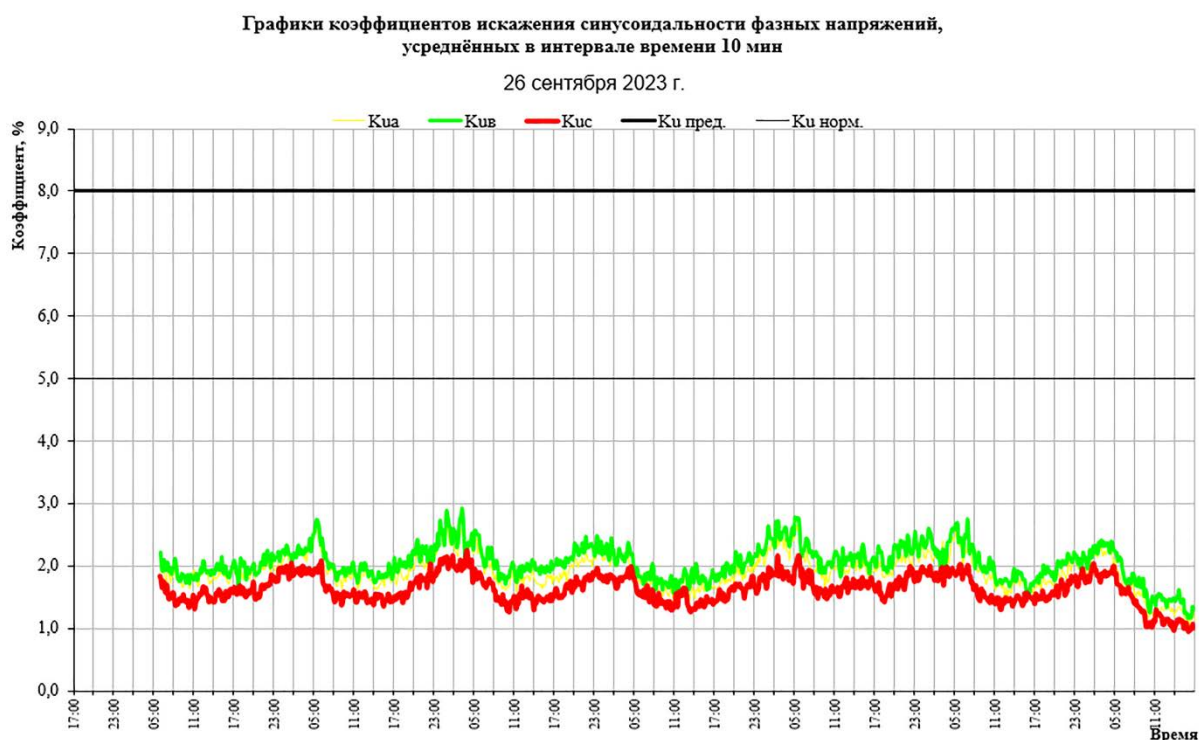
Рисунок 2 – Характеристика несинусоидальности напряжения
