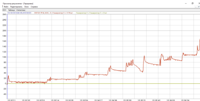
Рисунок 3.13. Диаграмма тарирования тензометрического датчика
