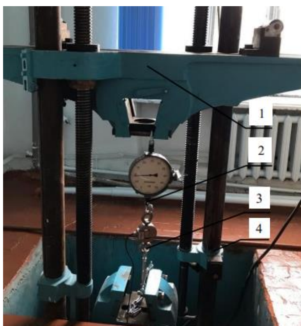
Рисунок 3.12. Общий вид лабораторной установки: 1 – подвижная балка; 2 – образцовый динамометр; 3 – S-образный тензорезисторный датчик; 4 – неподвижное основание
