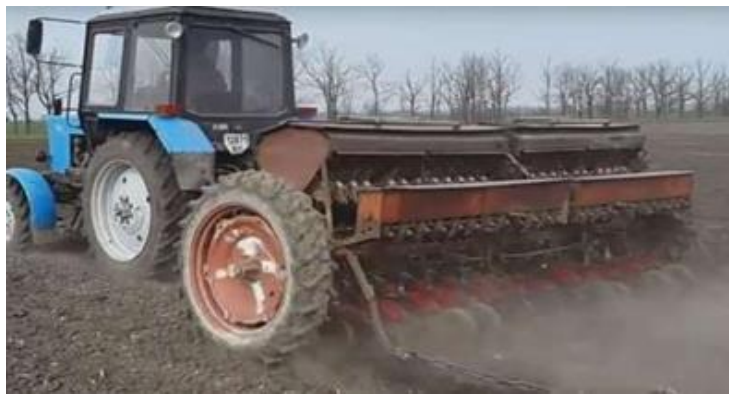
Рисунок 3.17. Усовершенствованные сошники зерновой сеялки СЗУ-3,6
