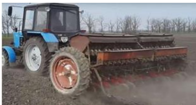
Рисунок 4.18. Модернизированные сошники сеялки зерновой узкорядной СЗУ-3,6
