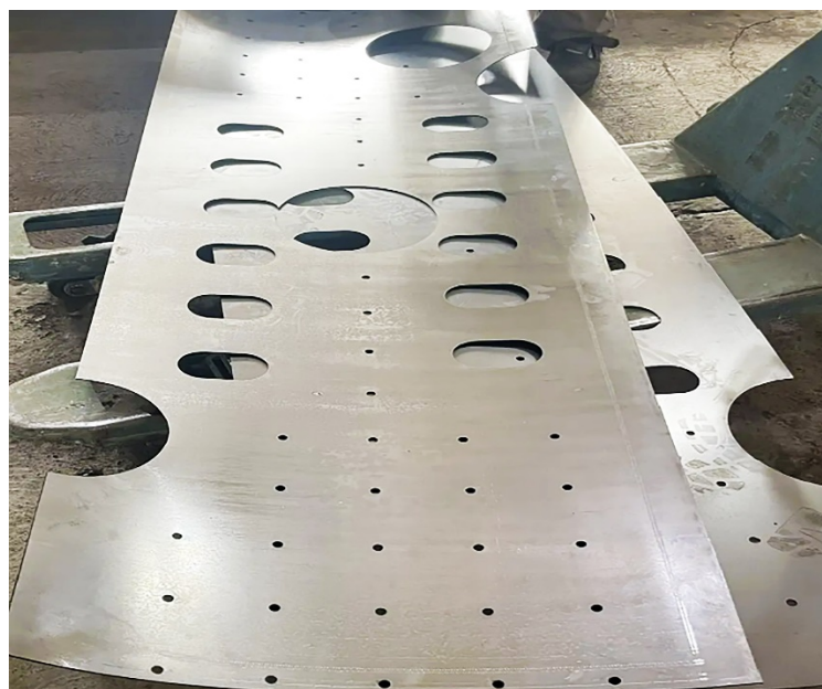
Рисунок 3 – Ремонтная накладка после изготовления
