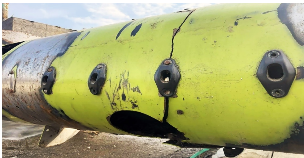
Рисунок 1 – Трещины консольного шнека CLAAS Maxflex 930
