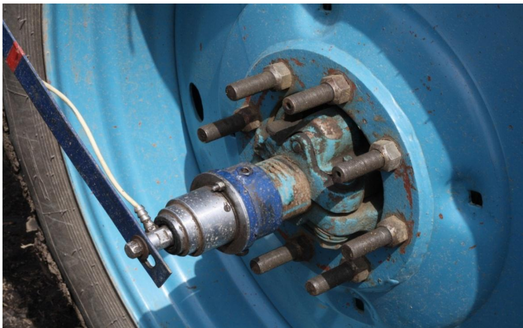
Рисунок 3.5– Измерение частоты вращения ведущих колес трактора
