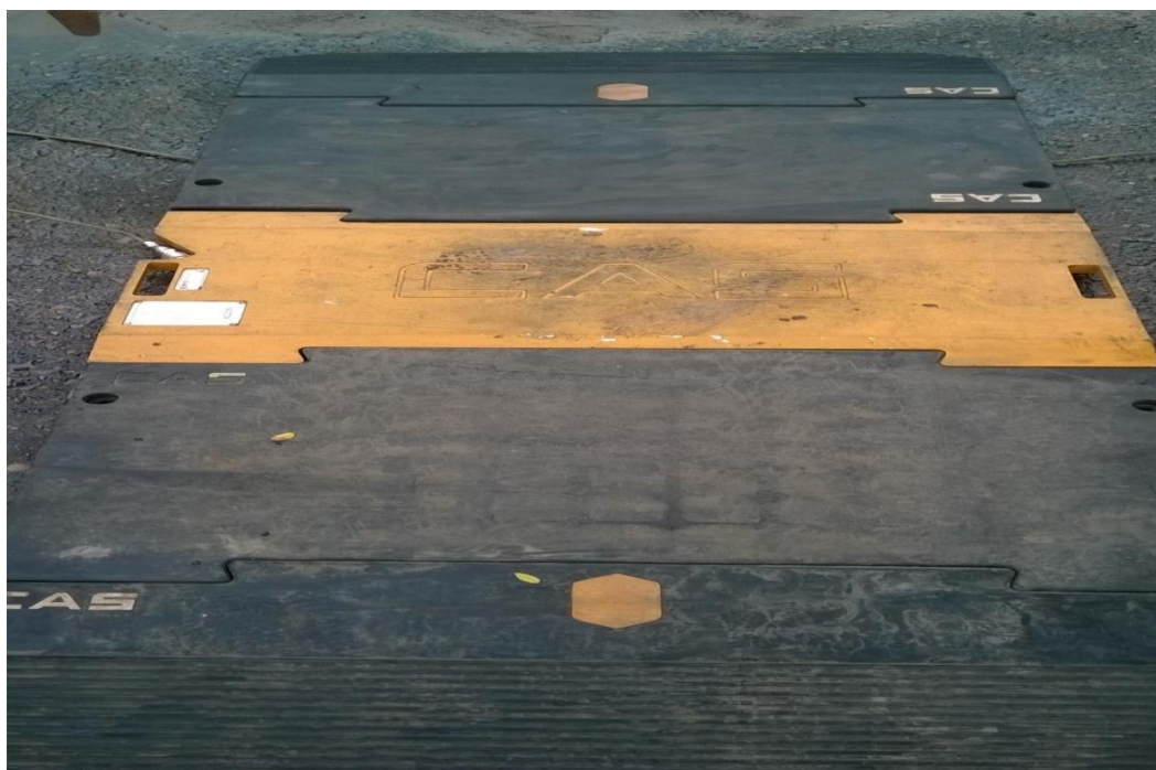
Рисунок 3.10– Весовая платформа с датчиками веса
