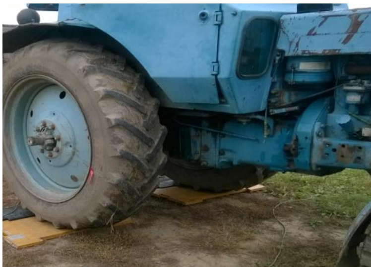
Рисунок 3.8– Фрагмент измерения веса приходящегося на колеса трактора
