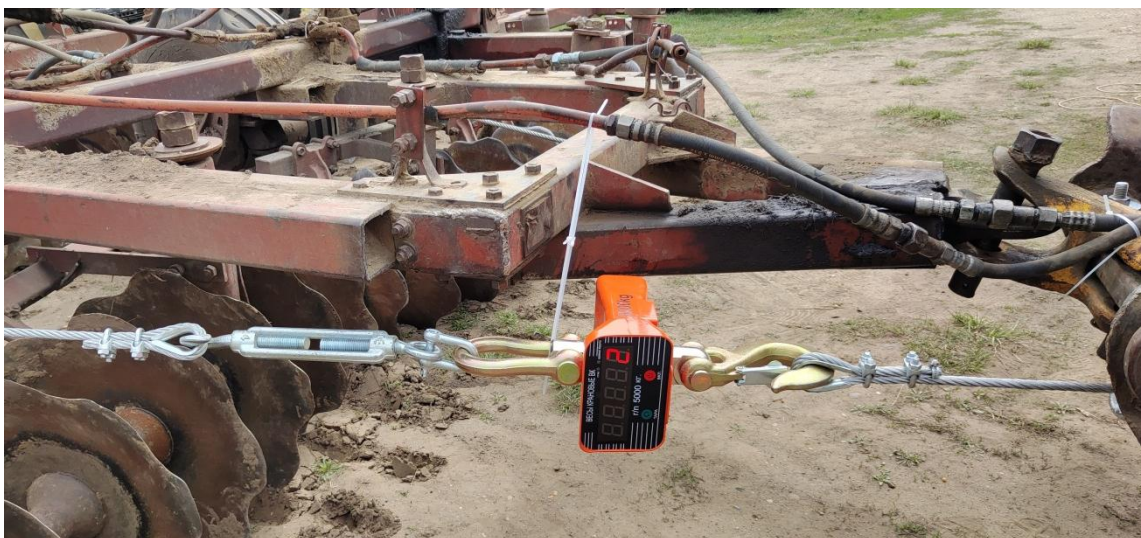
Рисунок 3.25 – Измерение усилия в гибкой тросовой связи корректора-распределителя сцепного веса
