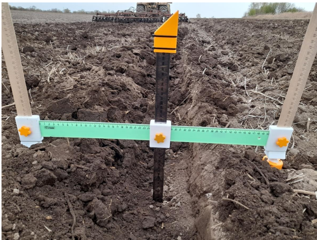
Рисунок 3.21 – Определение глубины обработки почвы
