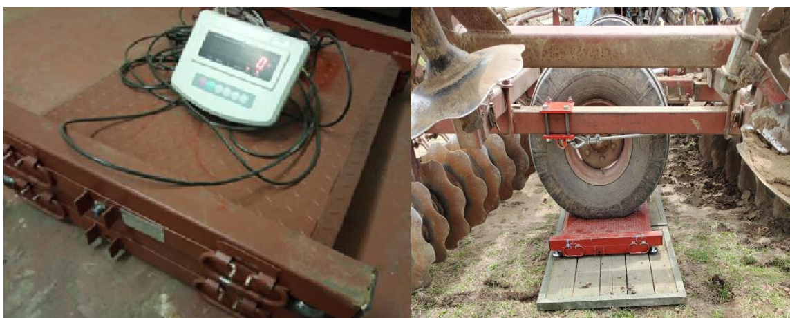
Рисунок 3.23 – Фрагмент измерения веса бороны
