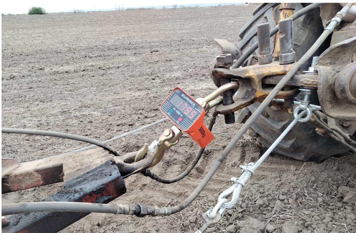
Рисунок 3.15 – Измерение тягового усилия на крюке МЭС
