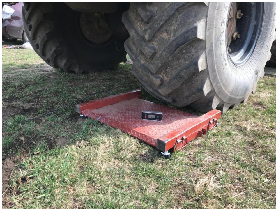
Рисунок 3.24 – Фрагмент выбора места проведения определения нагрузки на опорные поверхности
