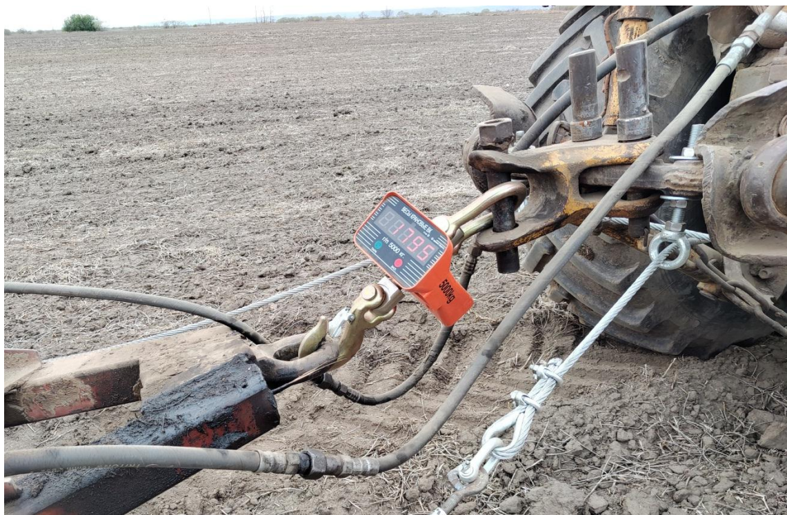
Рисунок 3.26 – Измерение тягового усилия на крюке МЭС
