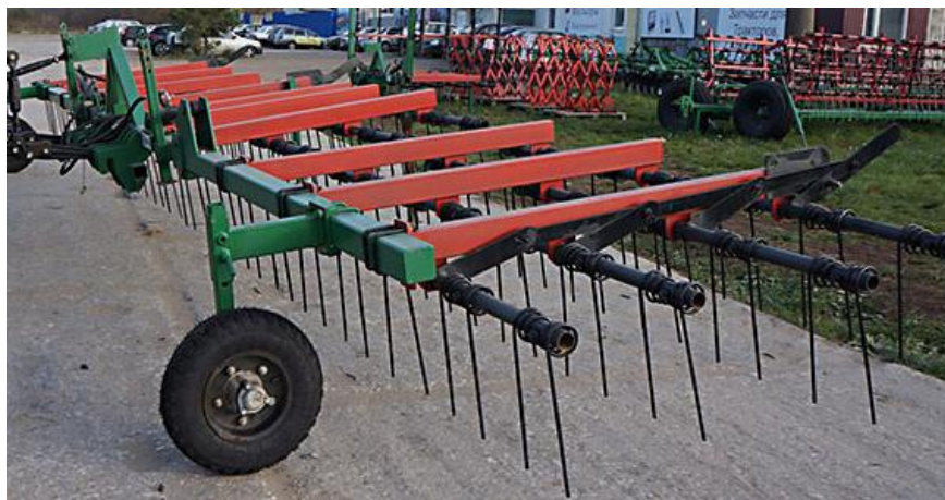
Рисунок 1.19 – Борона пружинная БП-12
