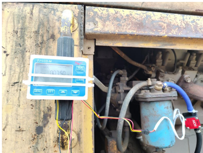
Рисунок 3.27 – Фрагмент измерения расхода топлива
