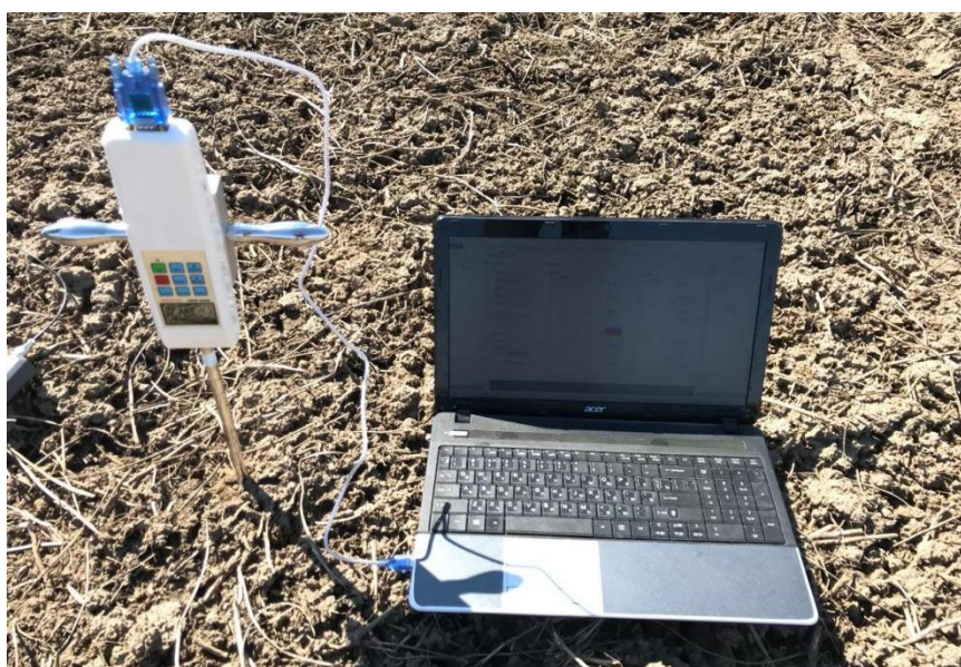
Рисунок 3.30 – Фрагмент измерения твердости почвы
