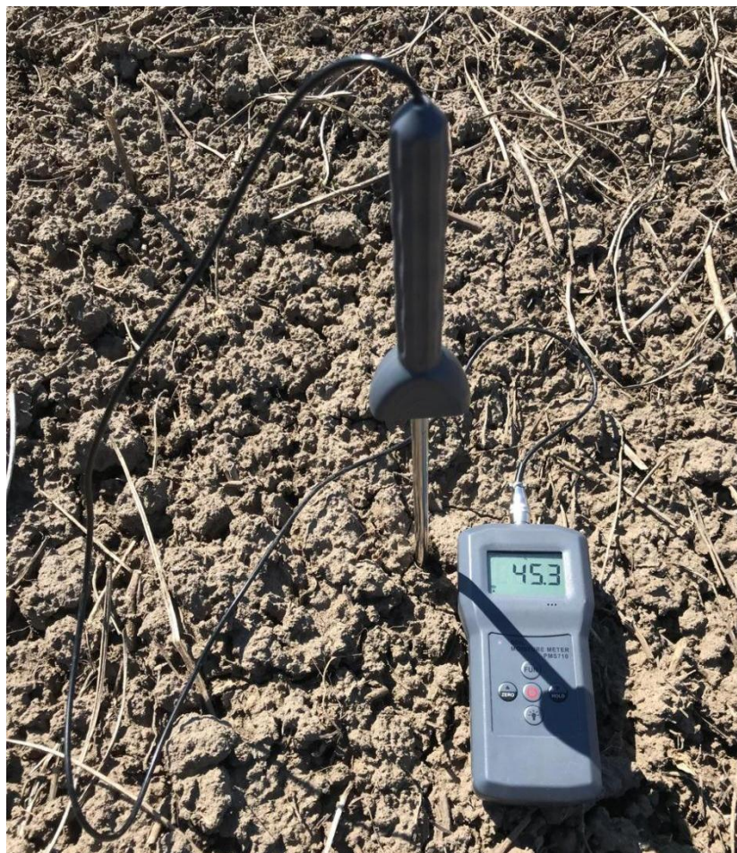
Рисунок 3.29 - Фрагмент измерения влажности почвы
