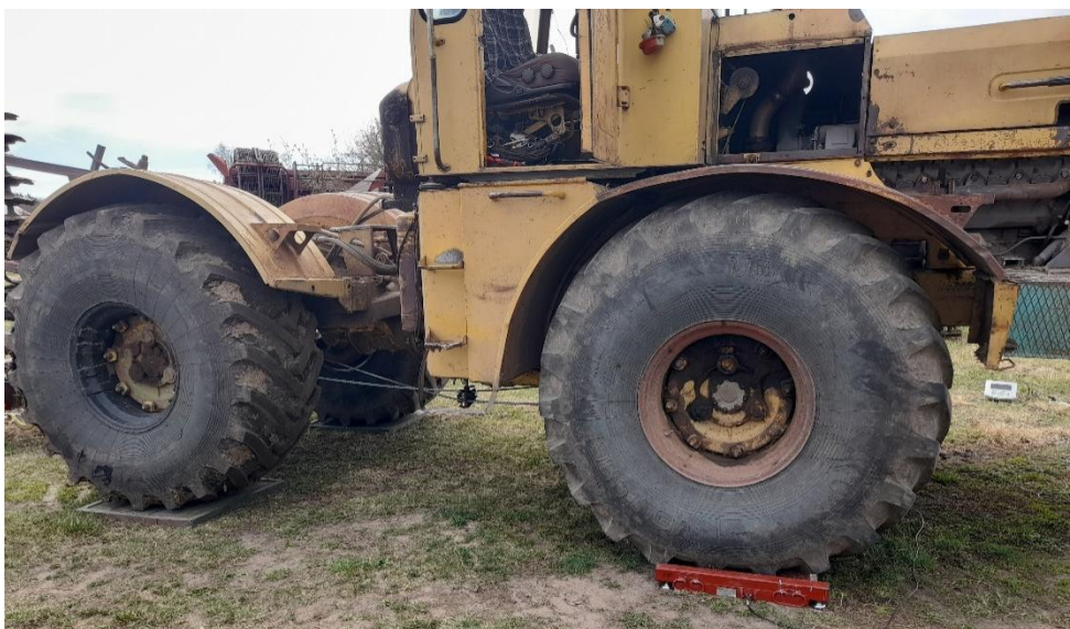
Рисунок 3.11 – Определение нагрузки на передние колёса энергетического средства
