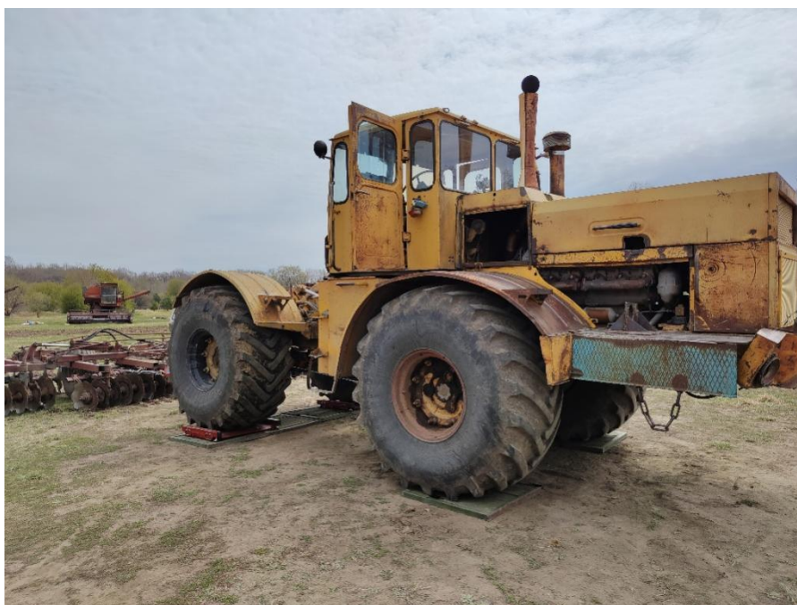
Рисунок 3.12 – Определение нагрузки на задние колёса энергетического средства
