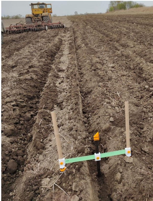
Рисунок 3.32 – Фрагмент измерения глубины обработки почвы
