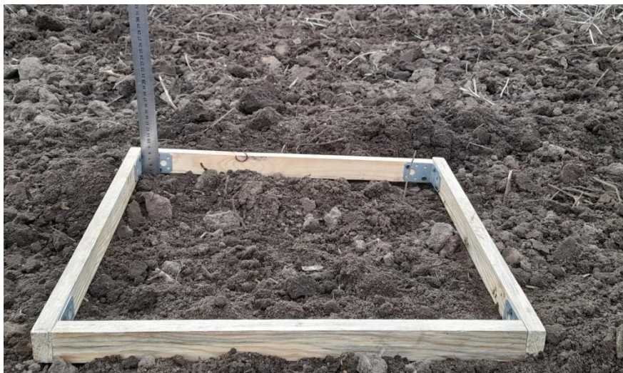
Рисунок 3.33 – Фрагмент определения комковатости почвы после прохода экспериментального МТА
