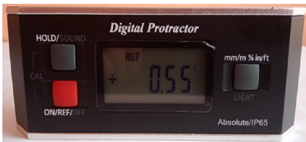
Рисунок 3.28 – Инклинометр Absolute Digital Protractor
