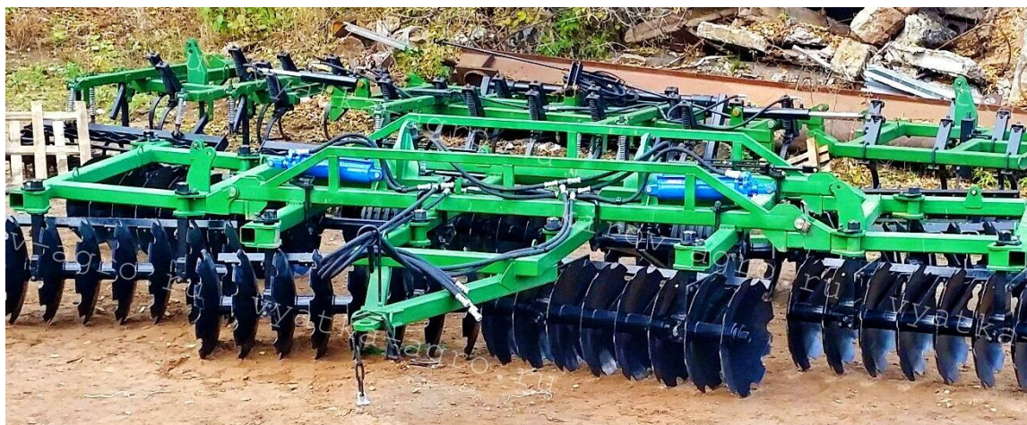
Рисунок 1.24 – Бороны дисковая тяжелая БДТ-7
