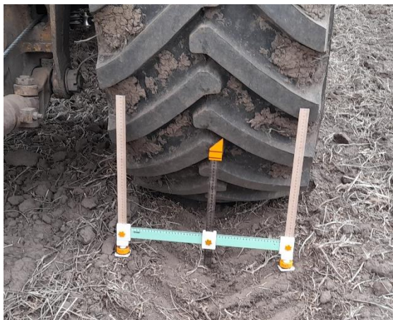
Рисунок 3.31 – Фрагмент измерения глубины колеи энергетического средства
