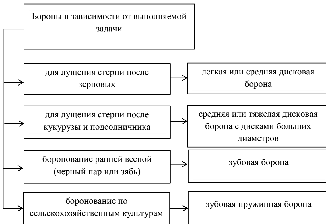
Рисунок 1.27 – Классификация борон по типу задач [88]
