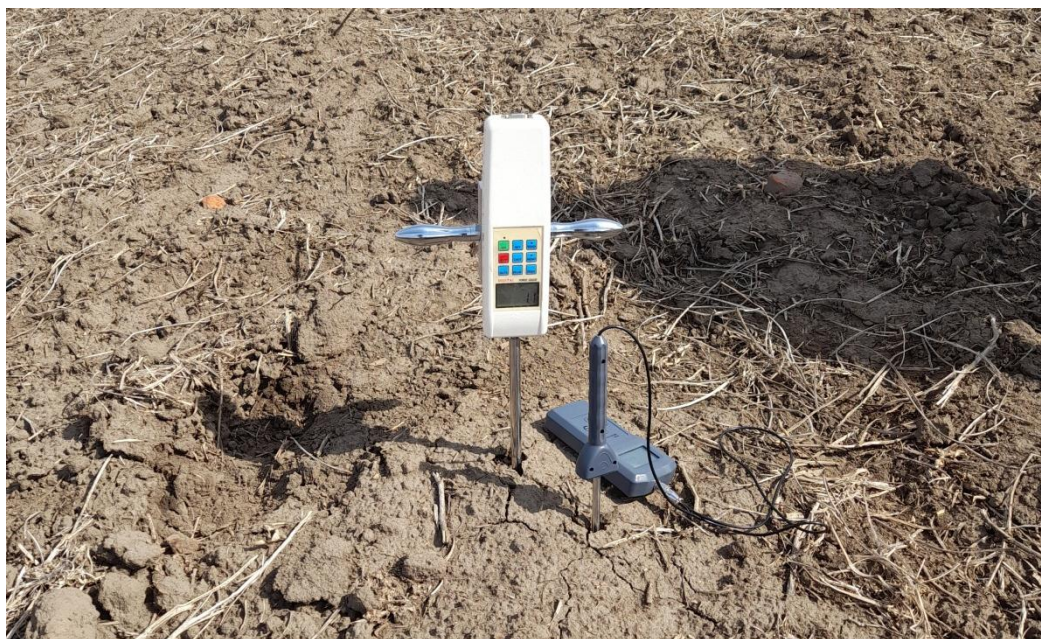
Рисунок 3.19 – Определение твёрдости почвы
