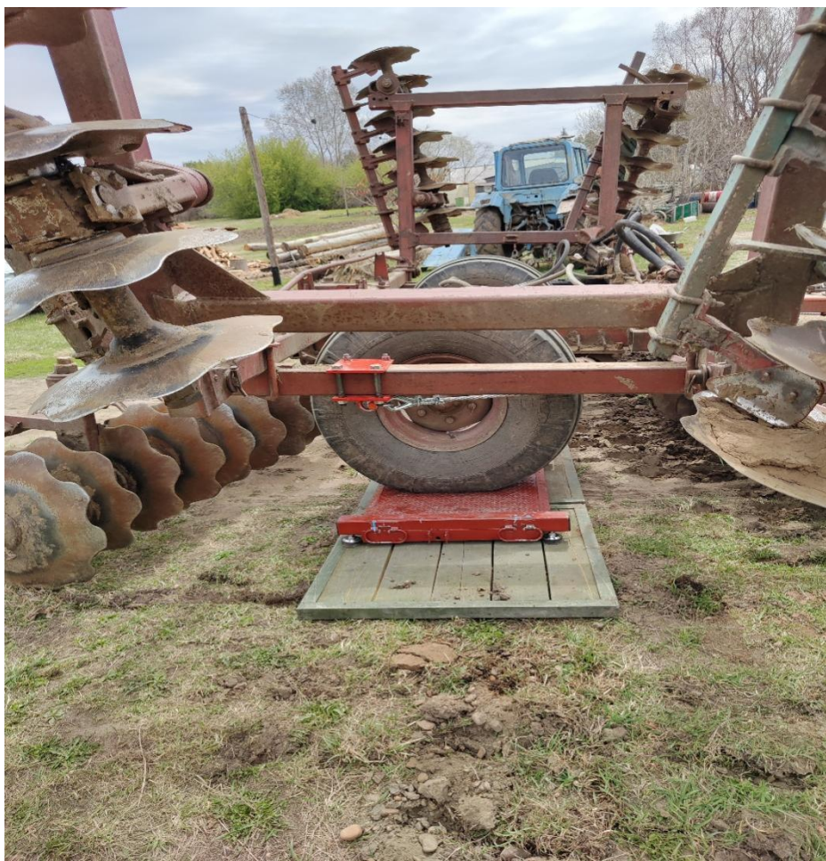
Рисунок 3.13 – Определение нагрузки на опорные колеса бороны
