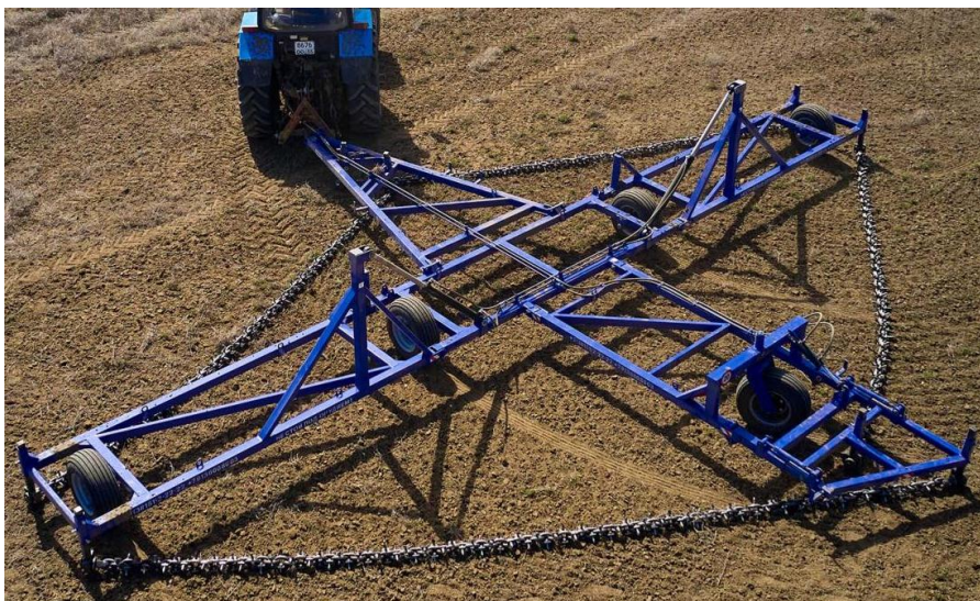
Рисунок 1.22 – Борона цепная Двуреченского БЦД-12М
