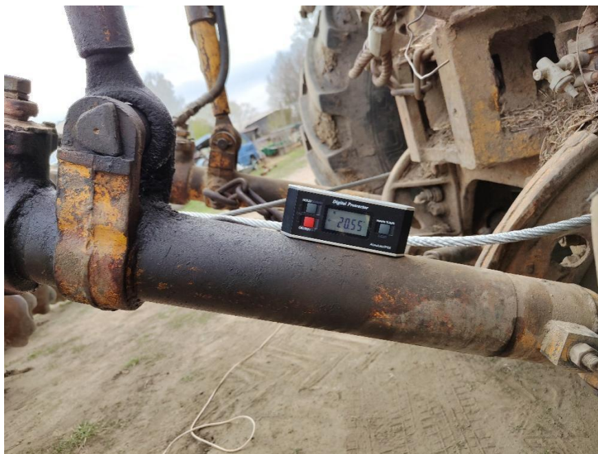
Рисунок 3.17 – Определение угла наклона тяг навески
