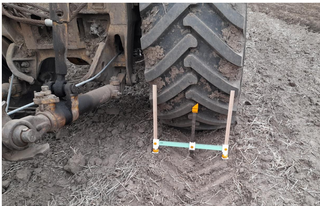
Рисунок 3.20 – Определение глубины колеи
