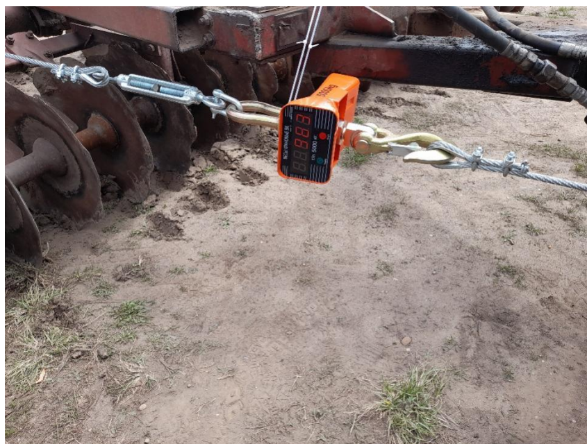
Рисунок 3.14 – Определение усилия передаваемого на МТА при работе устройства
