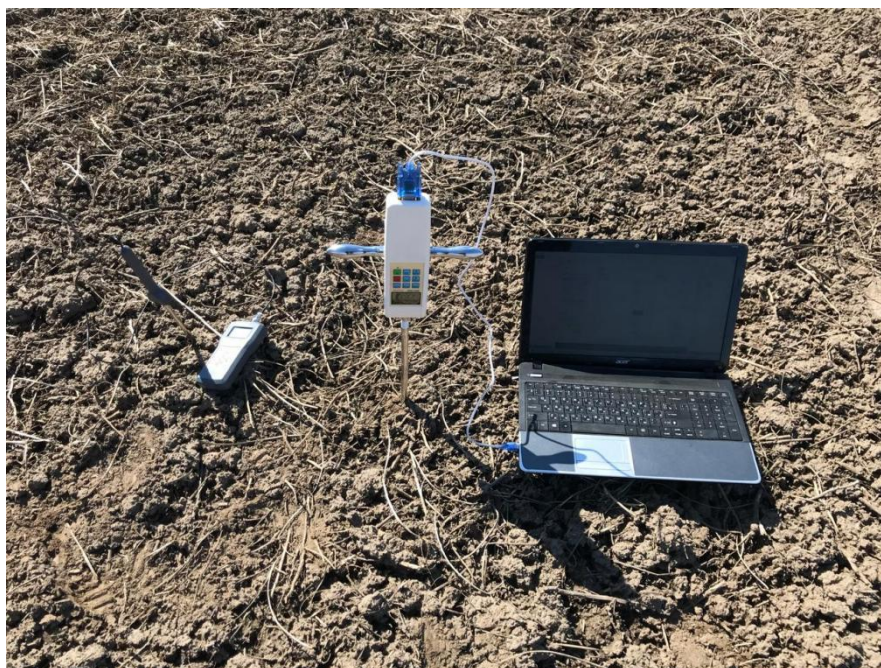
Рисунок 3.18 – Определение влажности почвы
