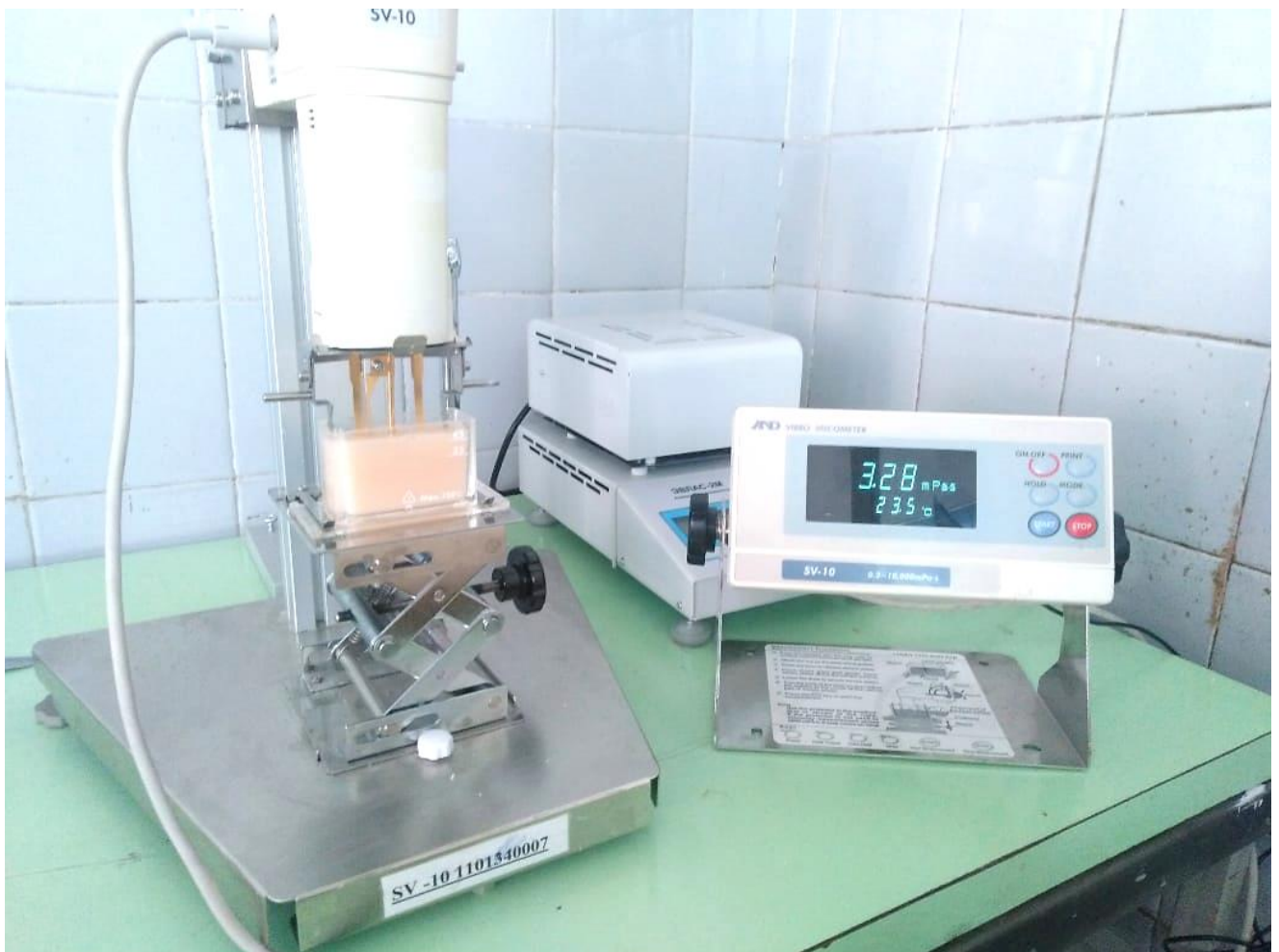
Рисунок 3.11 – Общий вид вибрационного вискозиметра SV-10 (A&D) в момент определения вязкости жидкой фракции
