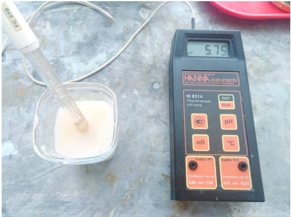
Рисунок 3.12 – Общий вид портативного прибора HI 83141 во время определения рН жидкой фракции
