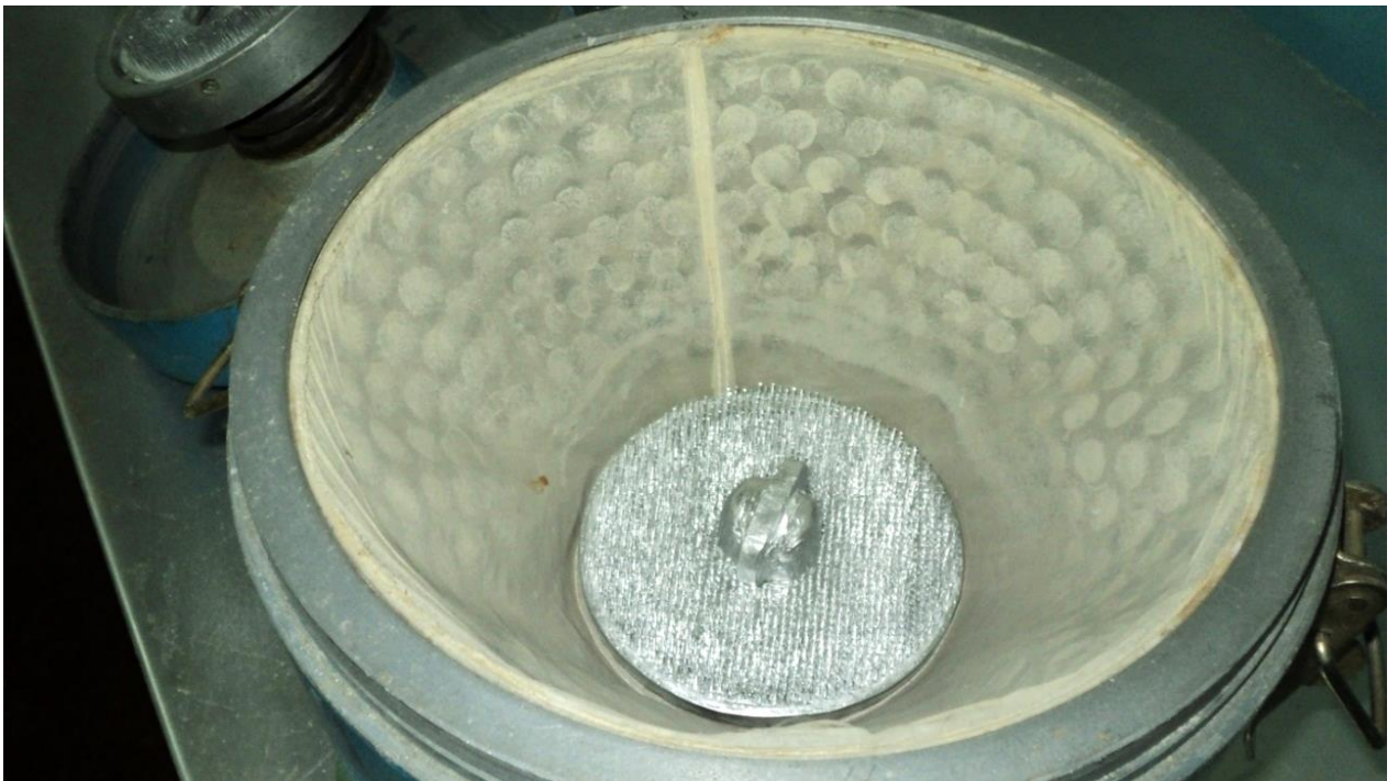
Рисунок 3.7 – Общий вид нижнего рабочего органа измельчающе-экстракционного узла
