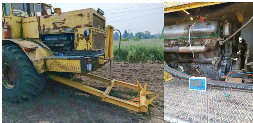
Рисунок 3.31 – Установка датчиков и сенсоров на экспериментальном энергетическом средстве
