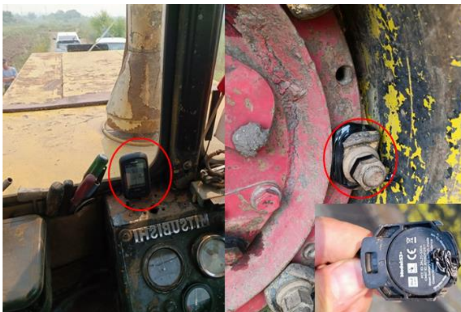
Рисунок 4.20 – Приборно-регистрационный комплекс MAGENE C406 Pro и установка датчика буксования
