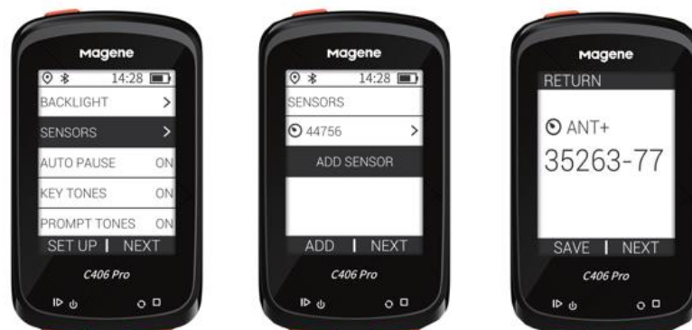
Рисунок 3.29 – Комплекс MAGENE C406 Pro для измерения пройденного расстояния, времени движения, скорости движения и частоты вращения ведущих колес энергетического средства
