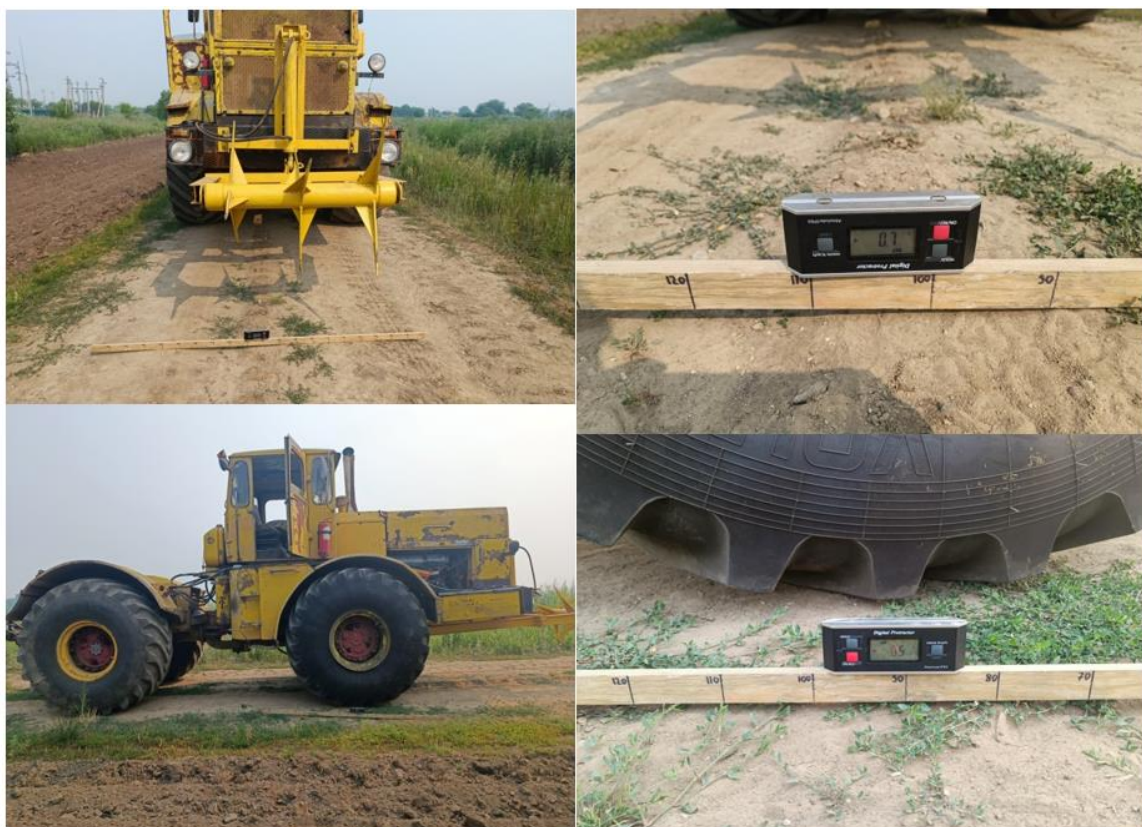
Рисунок 3.20 - Выбор весоизмерительной площадки и установка трактора при помощи инклинометра Absolute Digital Protractor
