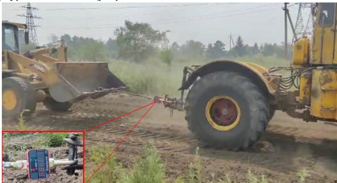
Рисунок 3.30 – Определение тягового усилия экспериментального колёсного трактора К-700А с навешанным устройством
