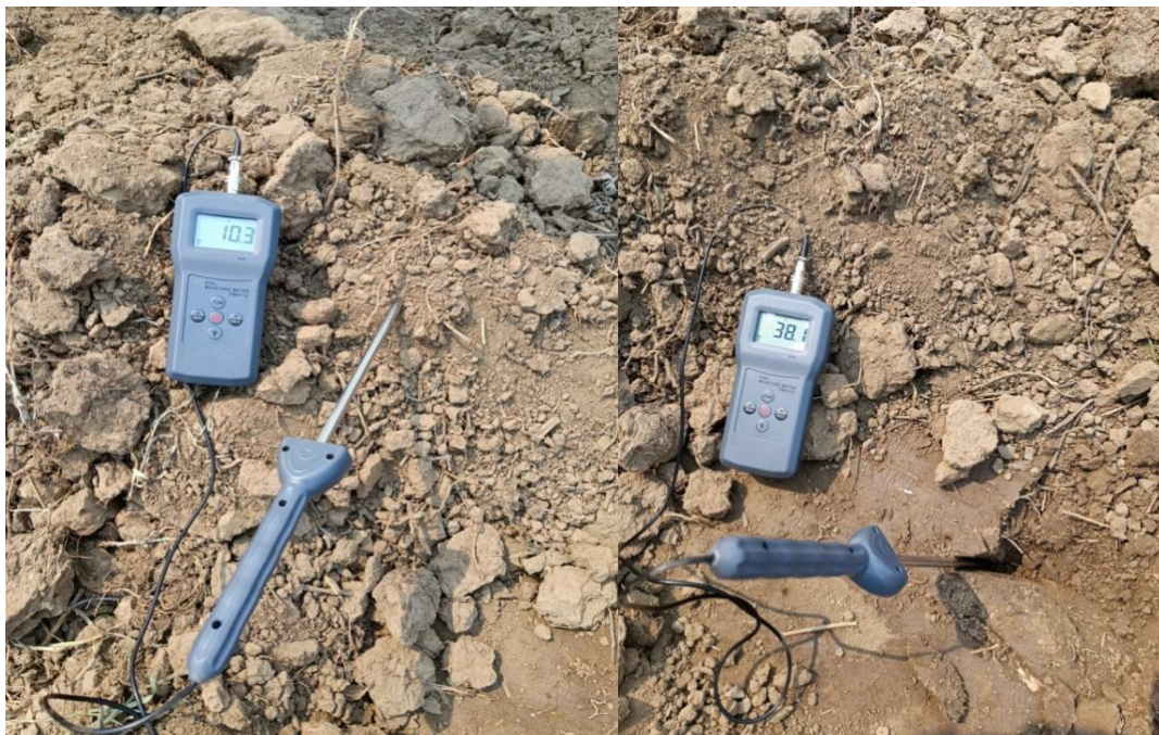
Рисунок 3.14 - Измерение влажности почвы с помощью влагомера и фиксацией полученных параметров.
