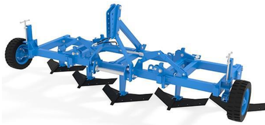
Рисунок 1.11 – Конструкция щелевателя-плоскореза глубокорыхлителя ПГ-3-5
