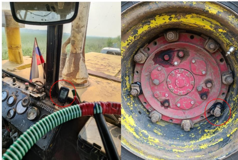
Рисунок 3.28 - Приборы для измерения частоты вращения ведущих колес, пройденного пути, времени опыта и рабочей скорости К-700А
