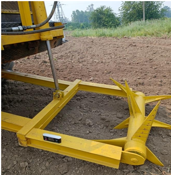
Рисунок 4.13 - Фрагмент измерения глубины прокалывания при изменении угла наклона рамы.
