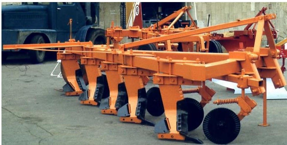
Рисунок 1.15 - Плуг-рыхлитель ПРПВ-5-50 с наклонными стойками типа «Параплау»
