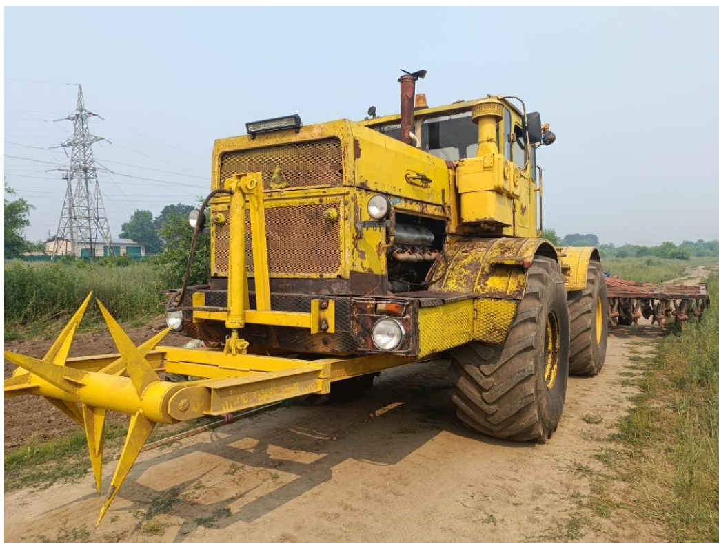
Рисунок 3.2 - Колёсный полурамный трактор К-700А экспериментальный с фронтальным прокалывателем-щелерезом
