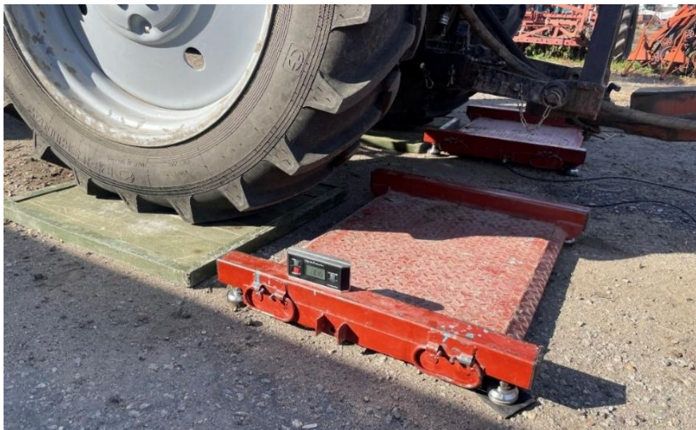
Рисунок 3.6 – Фрагмент измерения нагрузки, приходящейся на задние колеса энергетического средства (трактора) с помощью платформенных электронных весов МВСК(В)
