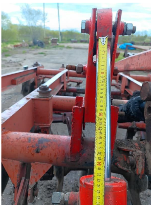
Рисунок 3.13 - Фрагмент измерения длины выхода штока гидроцилиндра
