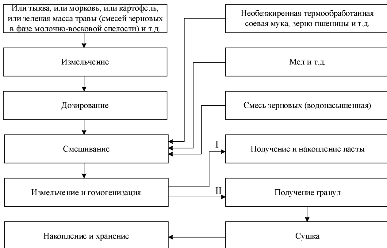
Рисунок 1.20 – Технологическая схема приготовления кормовых продуктов водоплавающей птице:
