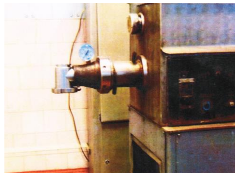
Рисунок 3П – К обоснованию величины давления в компрессионо-выравнивающей камере смесителя-гранулятора
