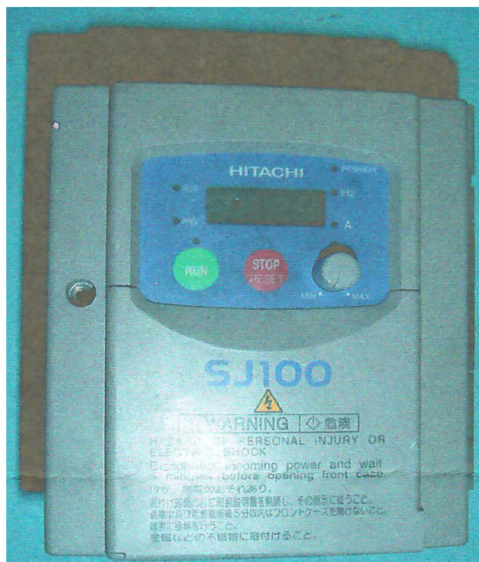
Рисунок 3.10 – Общий вид частотного преобразователя SJ100-022 HF фирмы «HITACHI»
