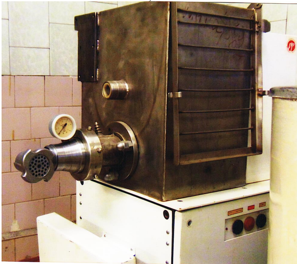
Рисунок 3.7 – Общий вид лабораторной установки по исследованию процессов смешивания и формования гранул:
