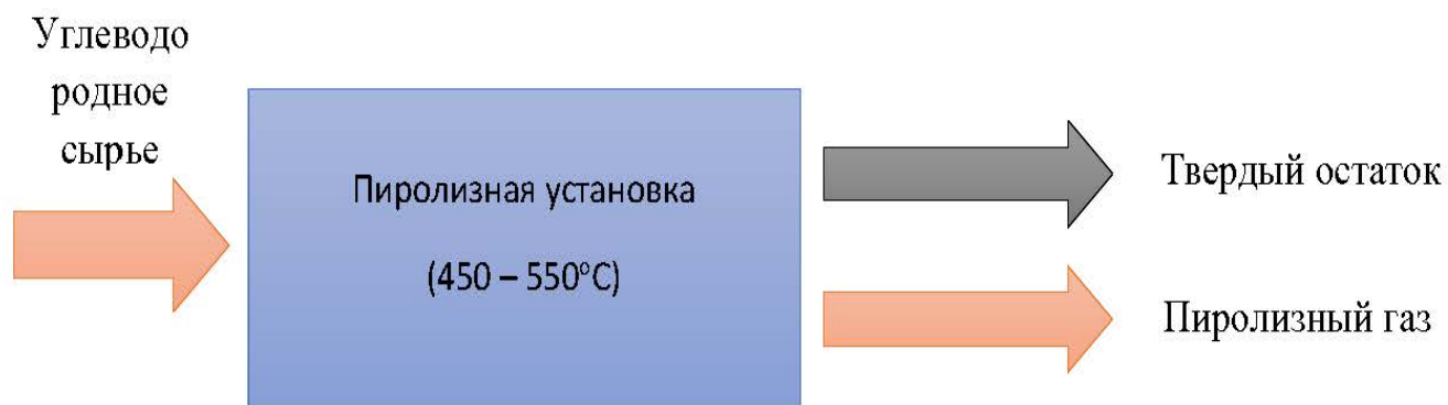
Рисунок 2.1 – Процесс термического разложения без доступа воздуха
