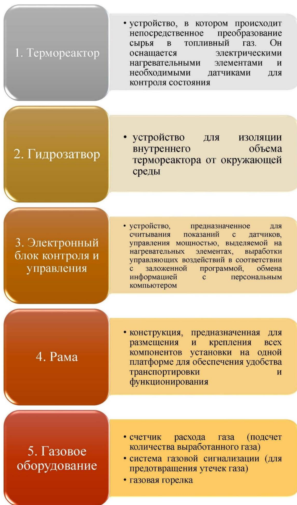
Рисунок 3.3 – Описание составляющих пиролизной установки ГВА – 1
