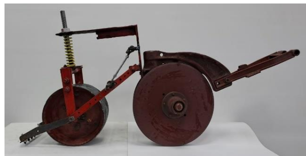
Рисунок 3. Схема и фото сошника с прикатывающим катком и рыхлителем: 1 – регулировочная пружина; 2 – прикатывающий каток; 3 – рассеиватель семян; 4 – профилеобразователь семенного ложа; 5 – сошник; 6 – тяга рыхлителя; 7 – зубья рыхлителя
