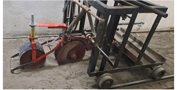
Рисунок 4. Схема и фото лабораторной установки: 1 – привод сошника; 2 – корпус; 3 – диск; 4 – профилообразователь семенного ложа; 5 – рассеиватель семян; 6 – привод катка; 7 – рыхлитель; 8 – прикатывающий каток; 9 – семенной ящик с высевальным механизмом; 10 – тяговая станция; 11 – нажимная пружина сошника
