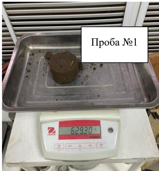
Рисунок 3.16 – Определение массы взятого образца почвы (определение плотности)
