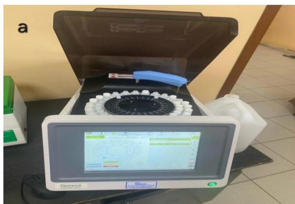
Рисунок 2 – Оборудование на котором проведены биохимические исследования крови: а – биохимический анализатор «Genrui gs 100», б – центрифуга лабораторная «ПЭ-6910»
