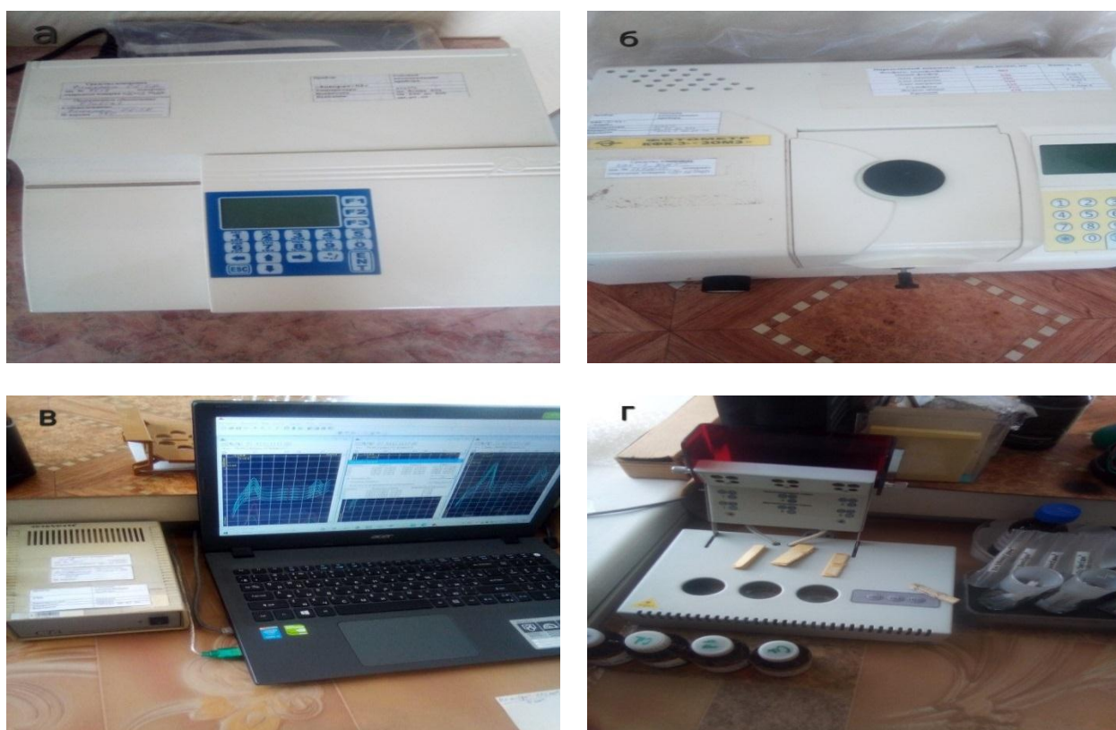
Рисунок 9 – Приборы для определения в воде содержания макро- и микроэлементов: а - анализатор ФЛЮОРАТ-02-5М, б - фотометр КФК – 3 - ЗОМЗ, в – комплекс вольтамперометрический СТА, г – комплекс вольтамперометрический СТА
