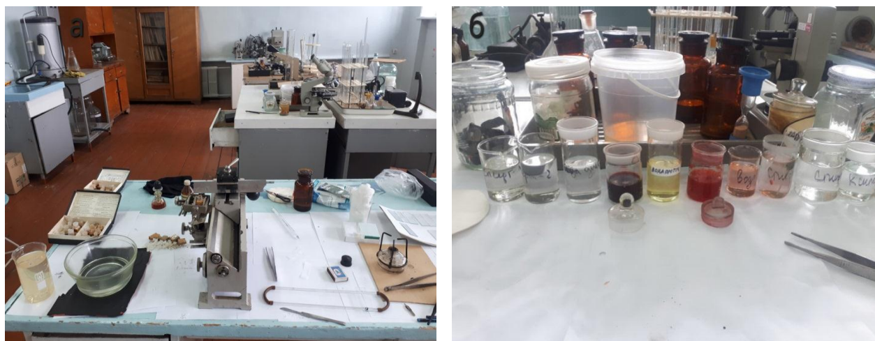
Рисунок 5 – Гистологическое исследование: а – приготовление гистологических срезов на микротоме «МС ТУ 64-1-1629-72», б – подготовка к окрашиванию гистологических срезов гематоксилином и эозином по Гейденгайну
