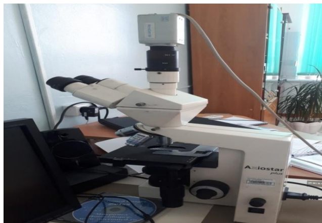
Рисунок 6 – Тринокулярный микроскоп «AXIOSTAR plus» со встроенной видеокамерой «MICROCAM 5M» и программным обеспечением «Micromed Images»
