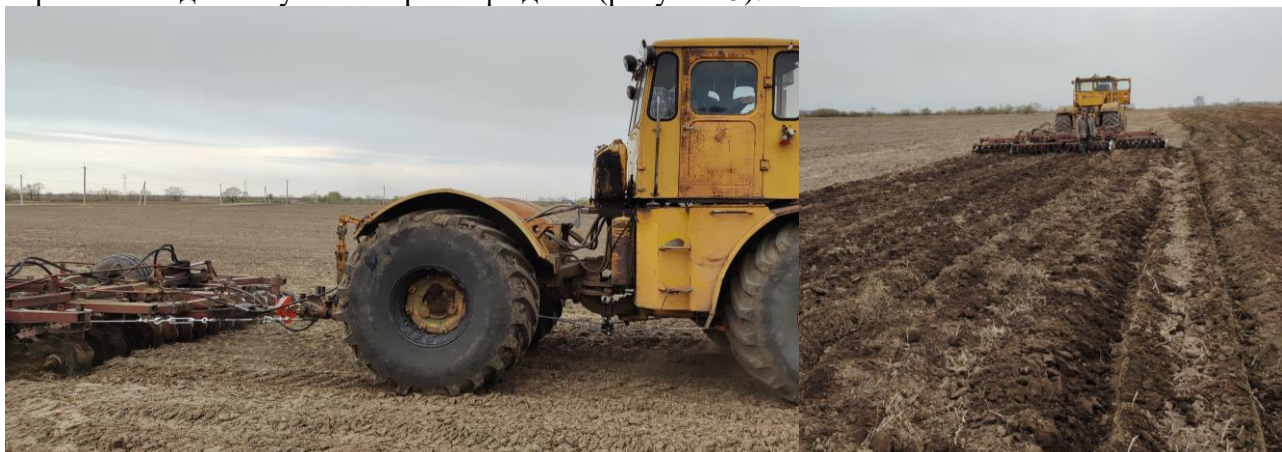
Рисунок 5 – Фрагменты испытаний экспериментального МТА с корректором-распределителем сцепного веса
