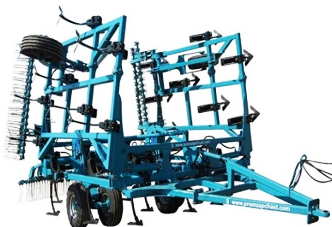
общий вид и рабочий орган культиватора стерневого КСТ-9300М
