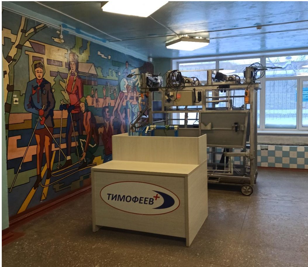
Рисунок 2 - Электрогидравлический станок для фиксации КРС марки «Комфорт плюс» производства ООО «Тимофеев+»
