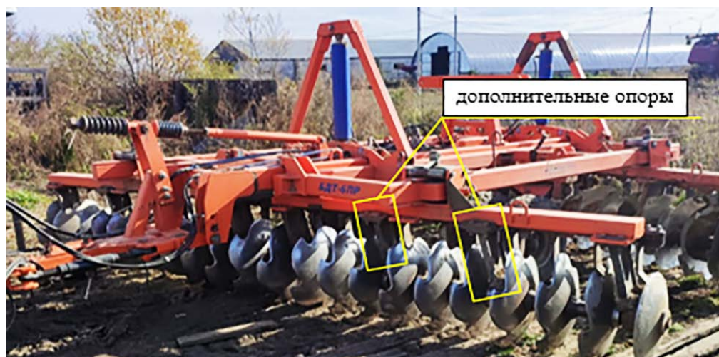
Рисунок 1 – Модернизированная дисковая борона БДТ-6ПР
