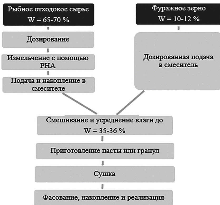
Рисунок 1 – Принципиальная технологическая схема производства высокобелкового-кормового продукта для индеек
