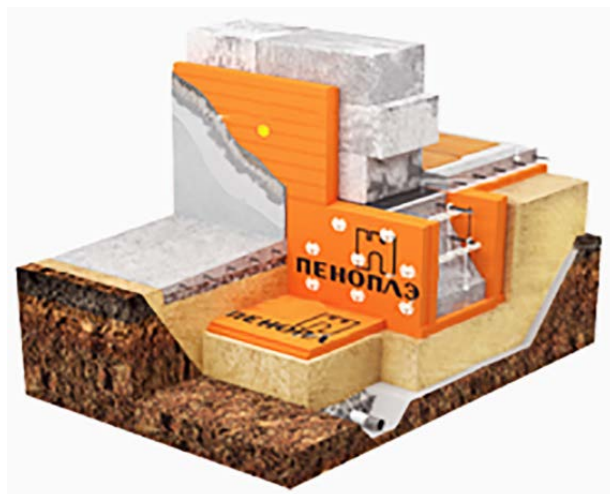
Рисунок 1 – Малозаглубленный ленточный фундамент с несъемной опалубкой
