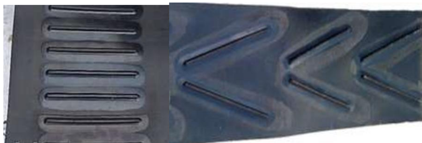
Рисунок 1.16. Ленты зернометательных машин: а – поперечная; б – «елочка»
