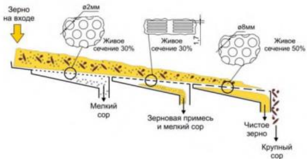
Рисунок 1.6. Схема работы решета сепаратора вороха универсального СВУ-60
