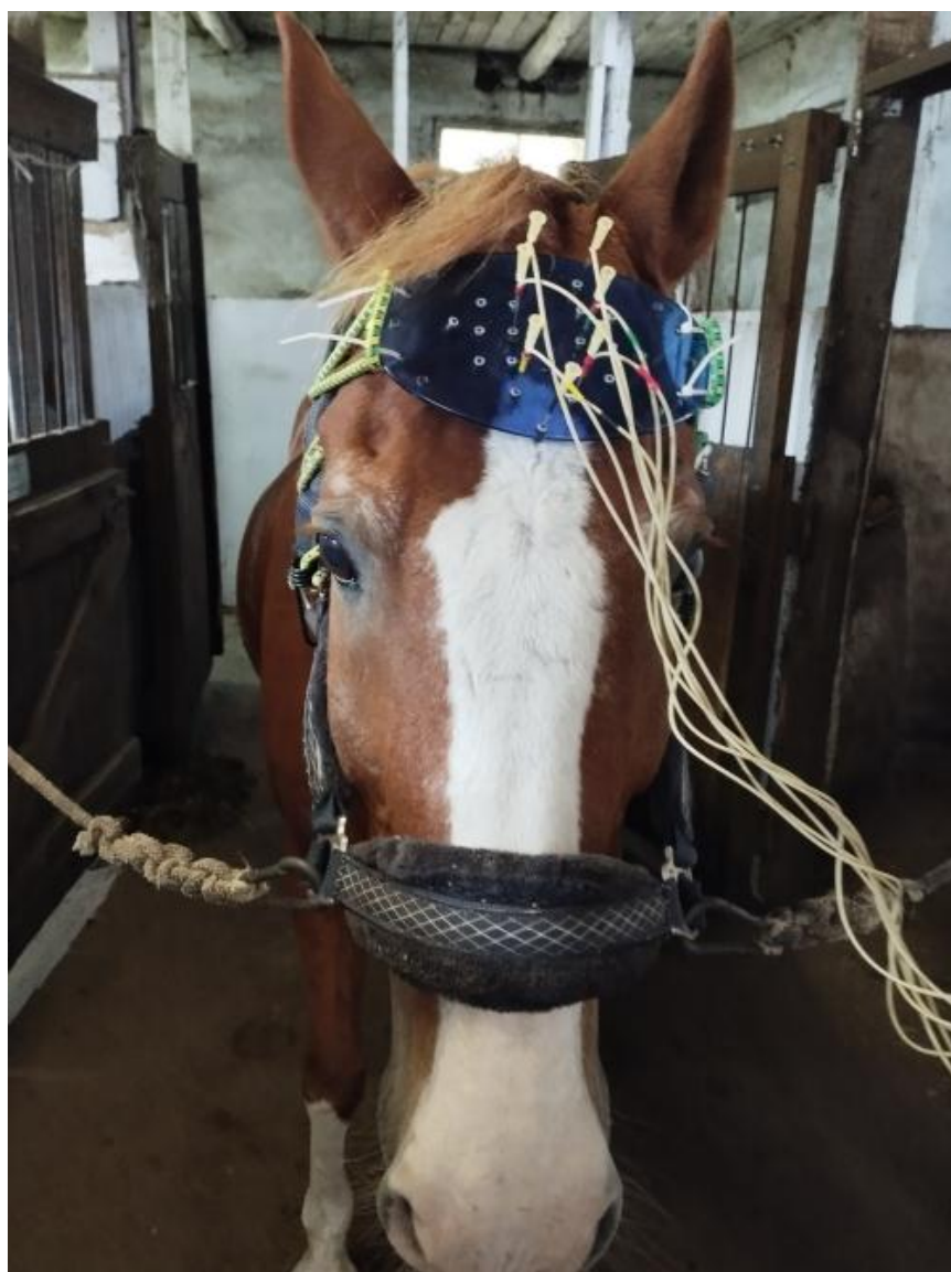
Рисунок 9 - Шлем Ипполитовой / Гаусс для регистрации ЭЭГ у животных
