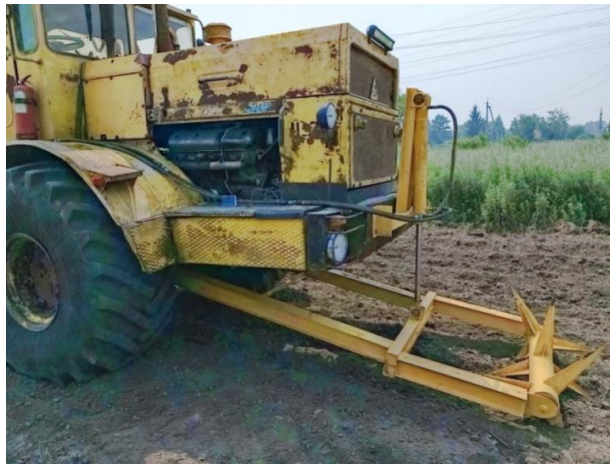
Рисунок 5 - Фрагмент испытаний экспериментального трактора с фронтальным прокальвателем-щелерезом
