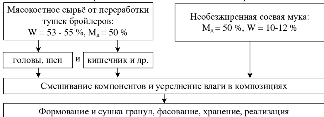
Рисунок 5 – Технологическая схема приготовления высокобелкового кормового продукта в виде гранулята
