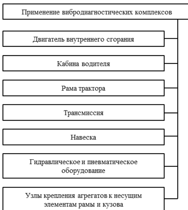
Рисунок 1.24 – Схема применения вибродиагностических комплексов
