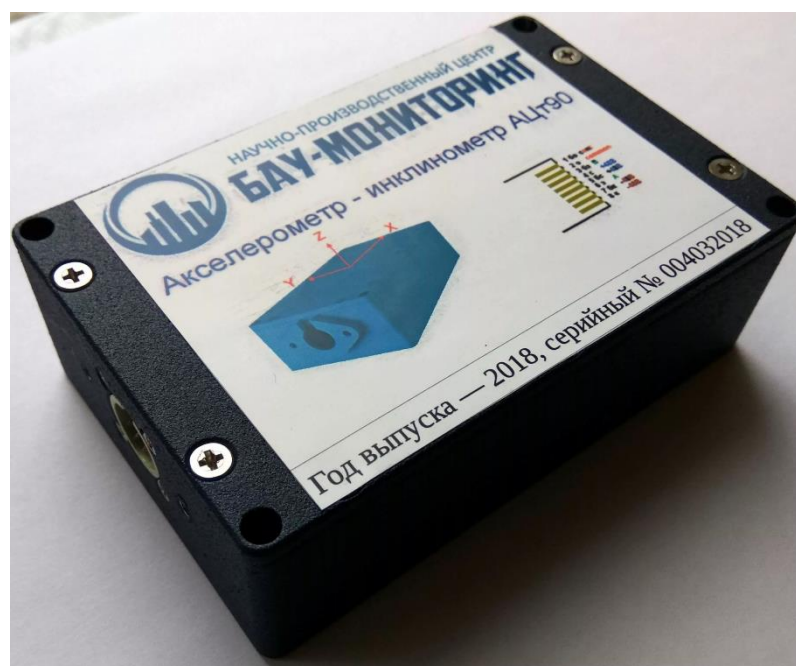
Рисунок 2.6 – Внешний вид вибродатчика акселерометра-инклинометра цифрового трёхосевого АЦт90
