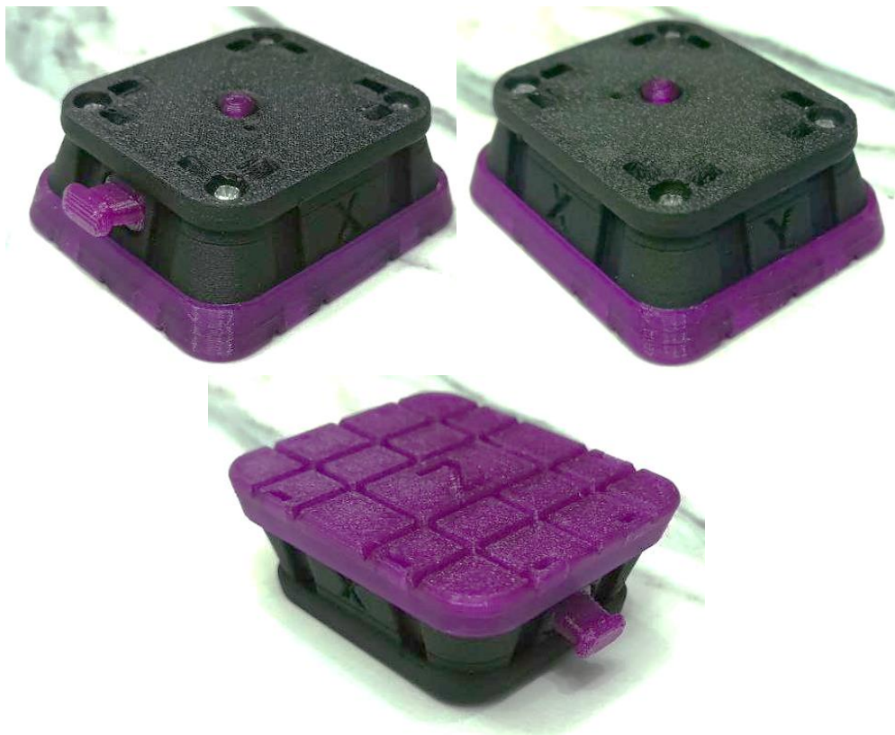
Рисунок 4.23 – Изготовленный на 3D принтере и собранный модернизированный корпус установочного элемента приборного комплекса
