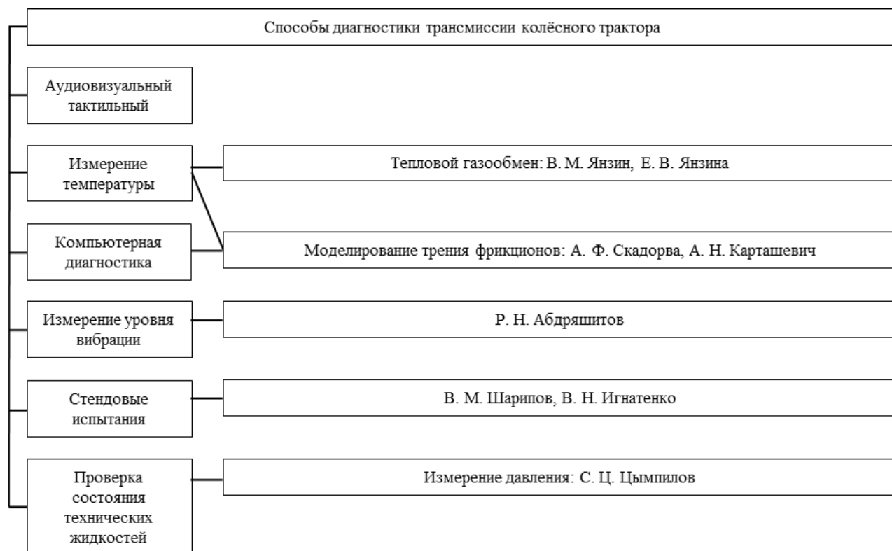
Рисунок 1.19 - Способы диагностики трансмиссии колёсного трактора
