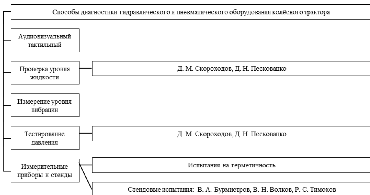
Рисунок 1.21 - Способы диагностики гидравлического и пневматического оборудования колёсного трактора
