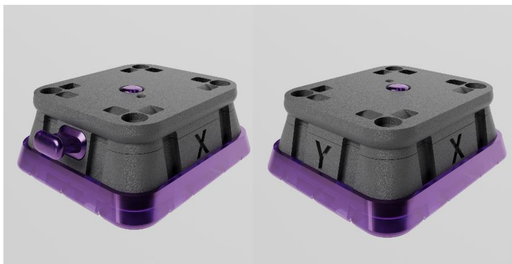
Рисунок 2.18 – 3D модель общего вида модернизированного корпуса в сборе
