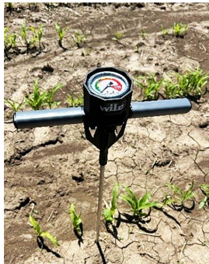
Рисунок 1 – Измерение твердости почвы ручным пенетрометром Wile Soil
