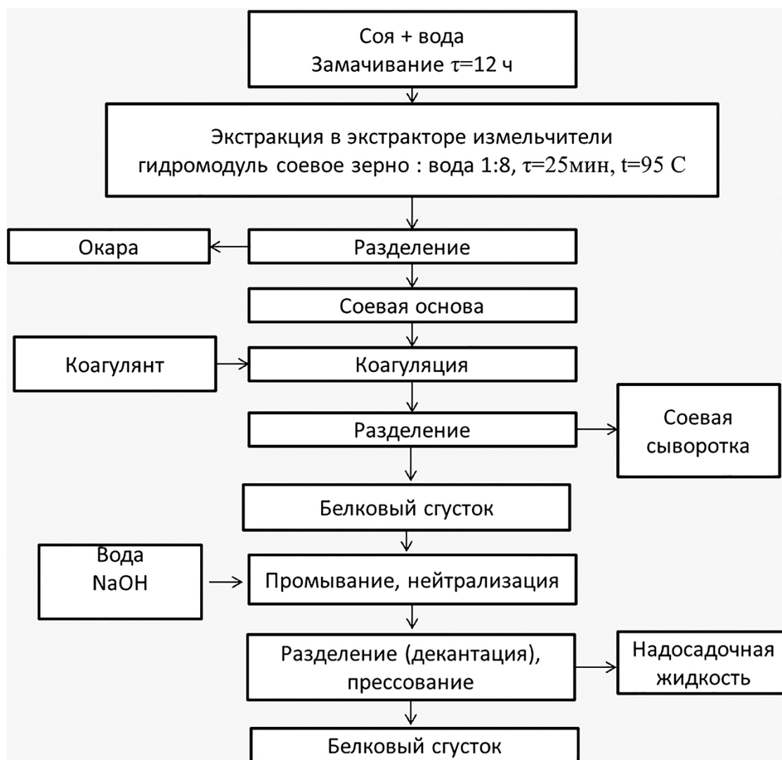
Рисунок 2 – Технологическая схема получения белкового сгустка из соевого зерна
