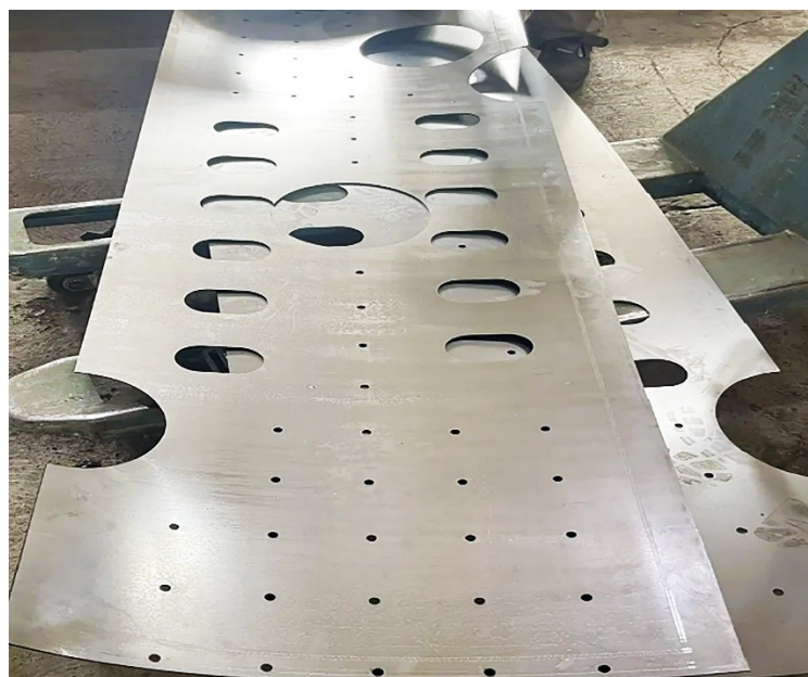
Рисунок 3 – Ремонтная накладка после изготовления
