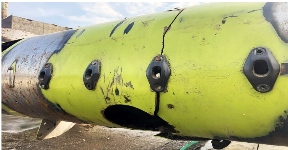
Рисунок 1 – Трещины консольного шнека CLAAS Maxflex 930
