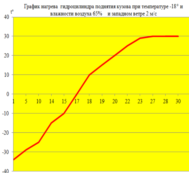
Рисунок 4 – График нагрева рабочей жидкости гидроцилиндра поднятия кузова
