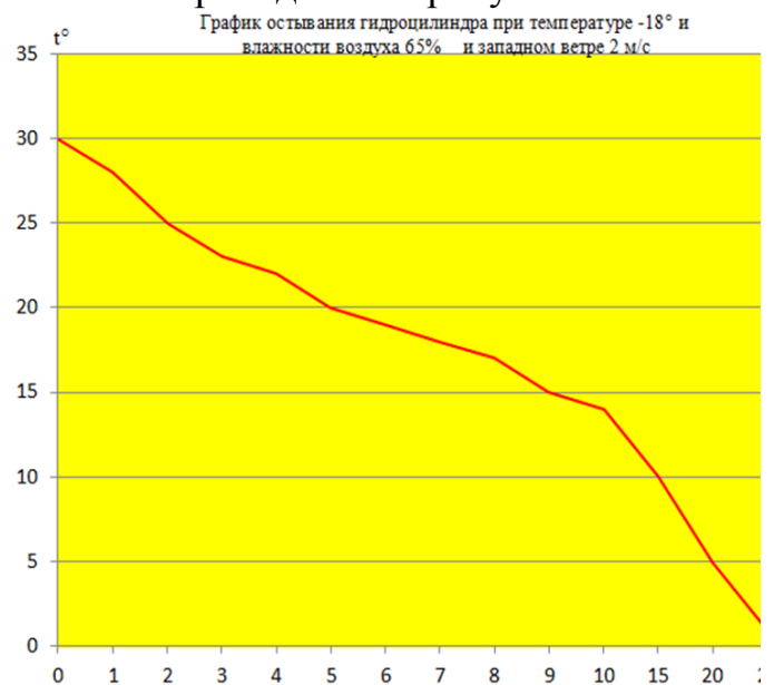
Рисунок 5 – График остывания рабочей жидкости гидроцилиндра поднятия кузова
