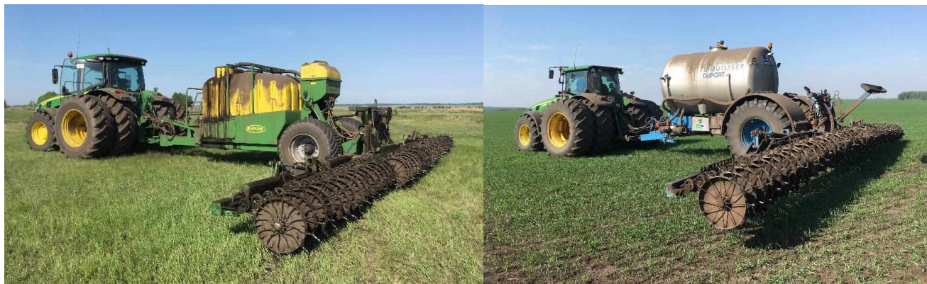
Рисунок 2 – Агрегаты для внесения жидких минеральных удобрений John Deere 8310R + Ликвилайзер «Алтай» (а) и John Deere 8430 + «Duport» (б)
