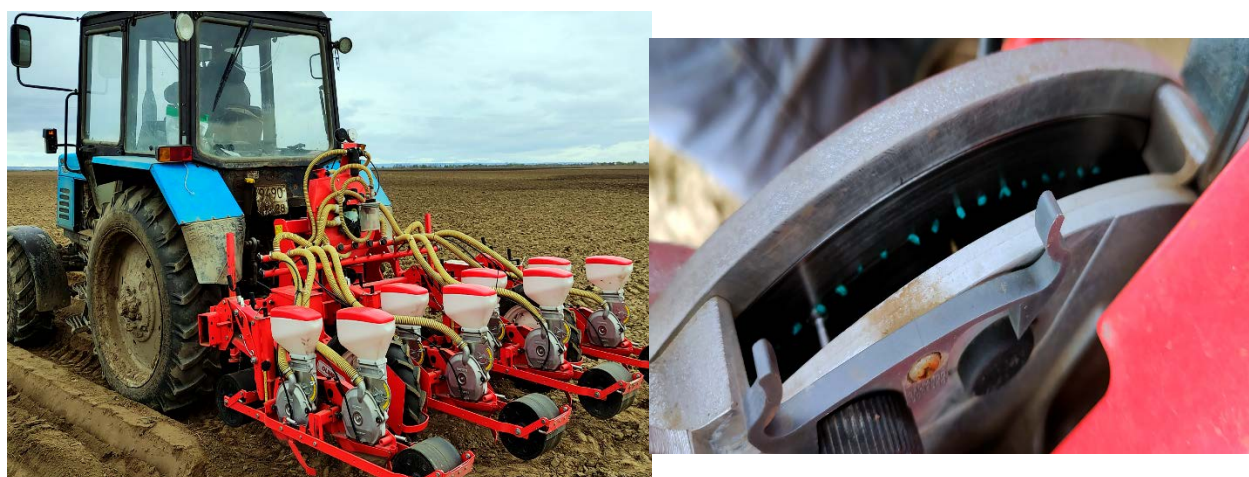
а) б) а) сеялка Gaspardo, агрегатируемая трактором МТЗ-82; б) высеваящий аппарат сеялки Gaspardo с семенами моркови
