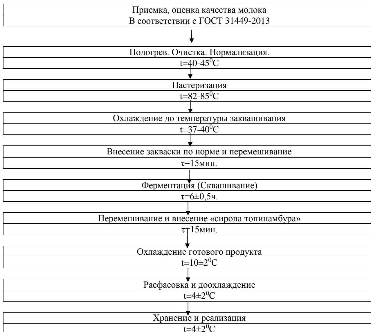
Рис.1. Блок-схема технологического производства молочного напитка, обогащенного сиропом топинамбура
