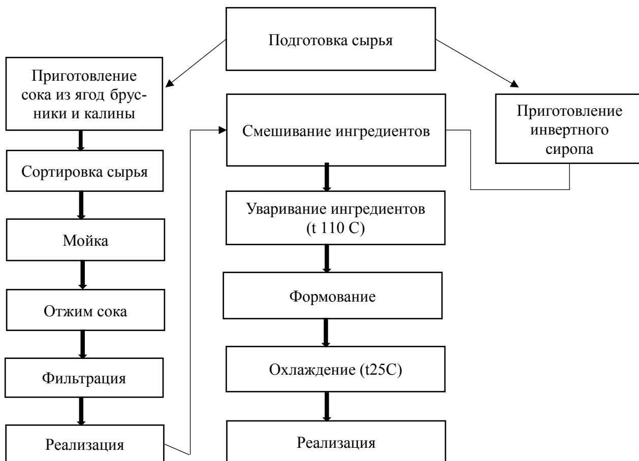
Рис. Технологическая схема приготовления образцов карамели с добавлением сока ягод калины и брусники
