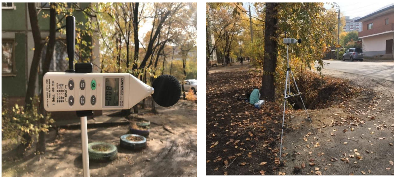
Рис. 2. Установка прибора CENTER-323 для измерения шумового загрязнения
