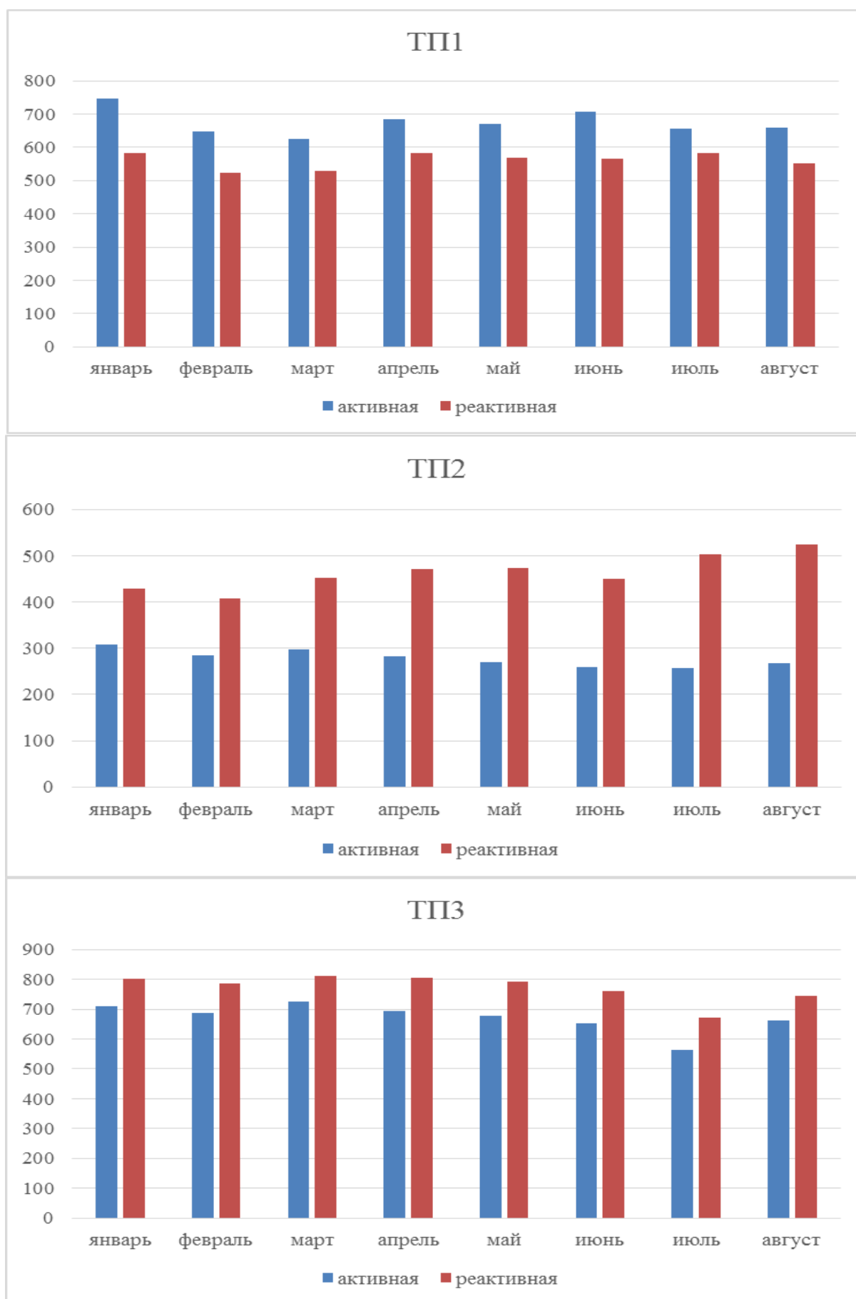
Рис. 2. График потребления активной и реактивной мощности
