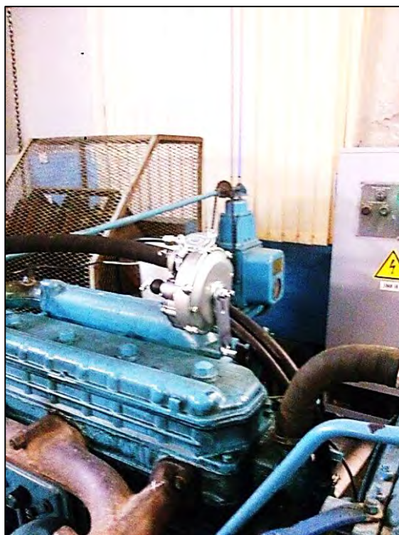
Рис.2. Редуктор газовый установленный на двигатель (Испаритель дозатор)
