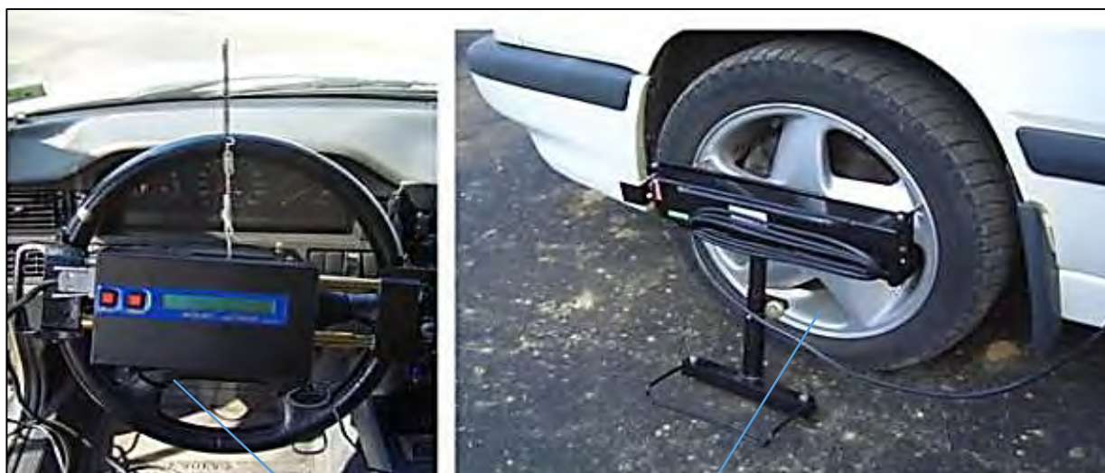
Рис.1. Прибор для проверки суммарного люфта в рулевом управлении АТС «ИСЛ-М»: 1- приборный блок; 2 - датчик движения колеса.
