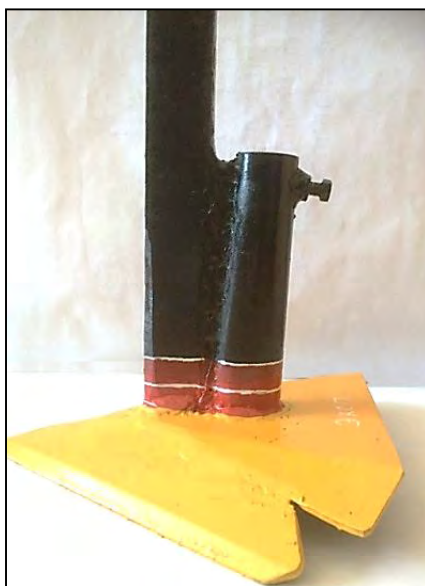
Рис.1. Экспериментальный рабочий орган сеялки СП-4,6. Лаповый сошник для посева сои полосой 18...20 см
