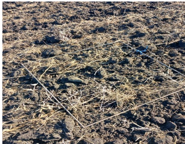
Рисунок 10 – Исследование комковатости почвы и её засоренности после прохода МТА New Holland t9.505 + Summers
