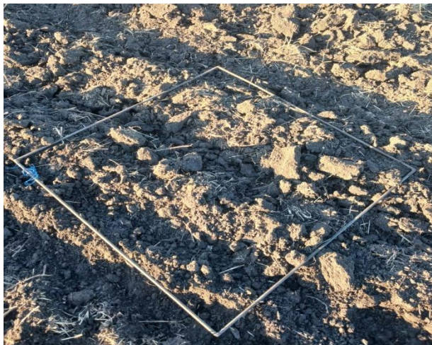
Рисунок 9 – Исследование комковатости почвы и её засоренности после прохода МТА K744p4 + Lemken kristall 9/600
