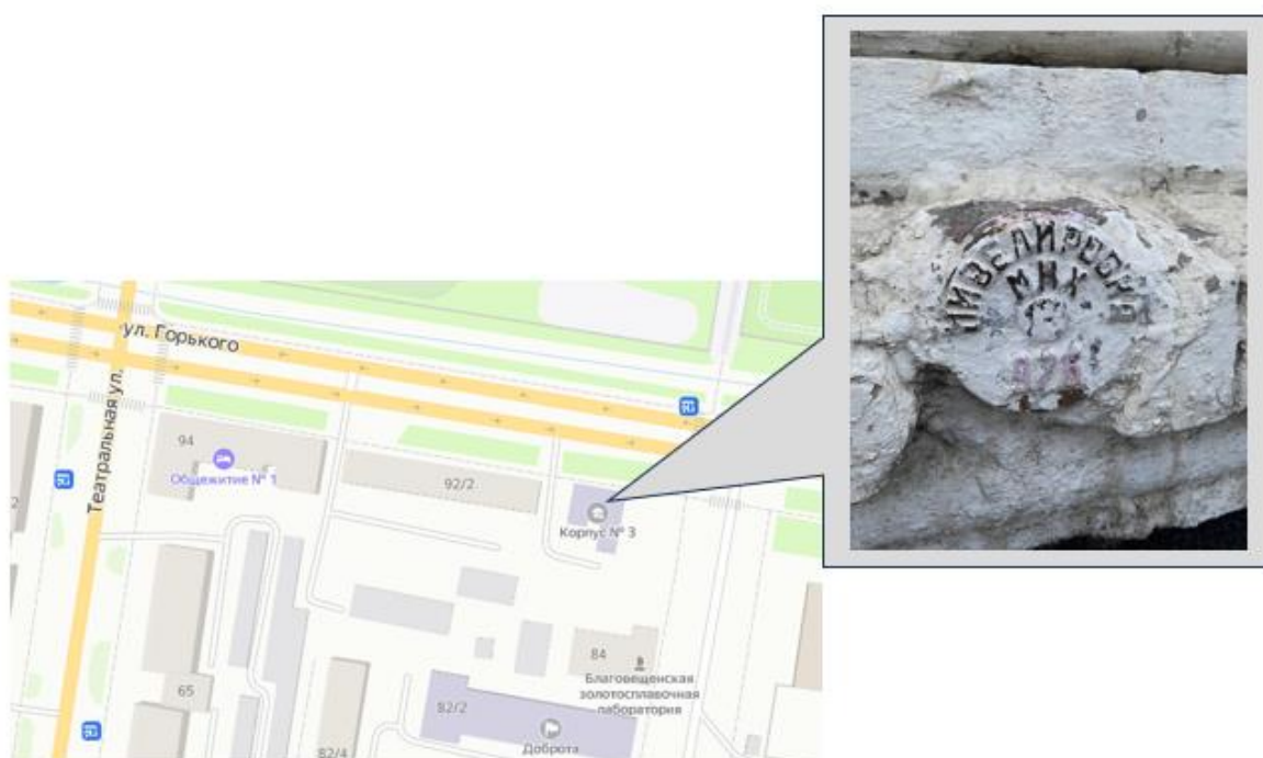
Рисунок – Пункт полигонометрии
