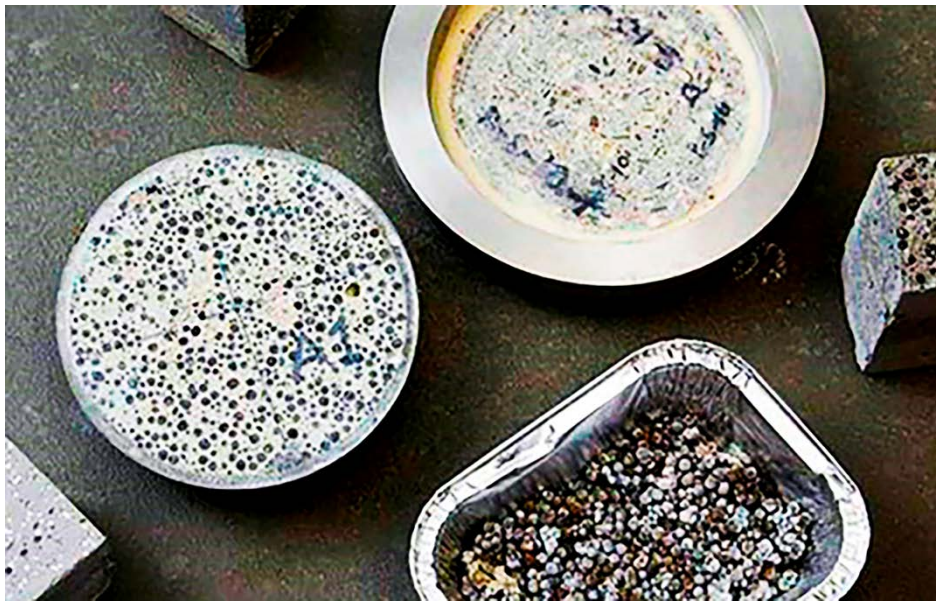
Рисунок 2 – Действие бактерий на поверхности бетона
