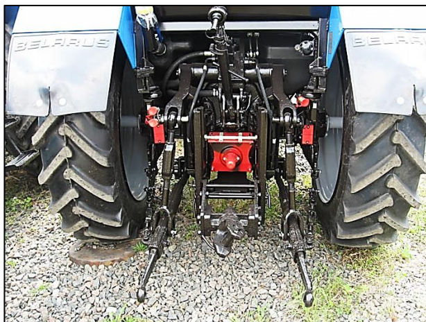
Рис.2. Фронтальный вид кормовой части трактора с гидронавесной системой
