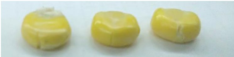
Рис.2. Зерно кукурузы после разрушения
