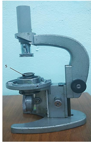
Рис.1. Прибор для измерения модуля упругости зерна: 1 – рама; 2 – подвижная штанга; 3,4 – площадка; 5 – пружина; 6 – часовой индикатор; 7,8 – винты
