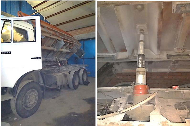
Рис.2. Установка ленточного кольцевого электронагревательного элемента на гидросистему поднятия кузова автомобиля КамАЗ-65115
