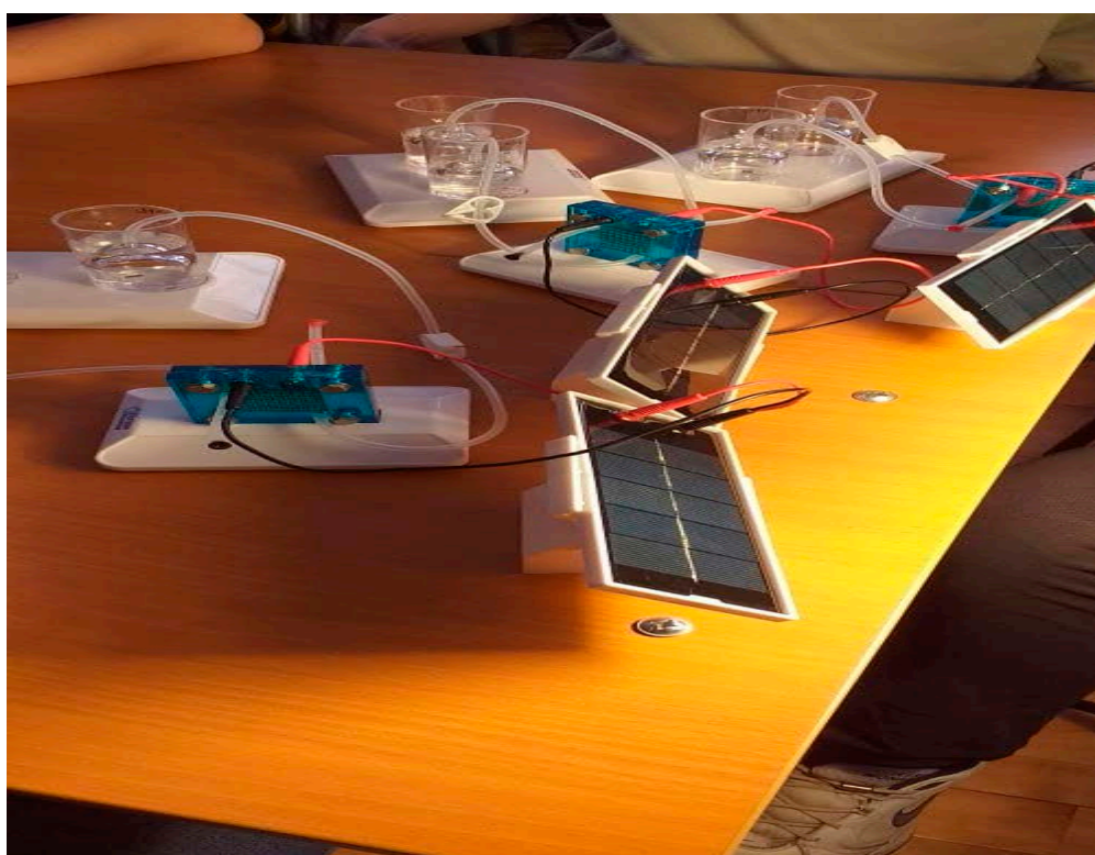
Рисунок 3 – Установки для получения водорода с использованием солнечной батареи
