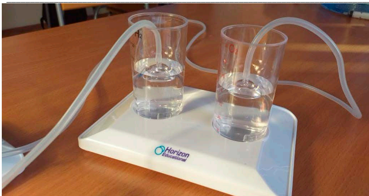
Рисунок 4 – Процесс получения водорода без использования солнечной батареи
