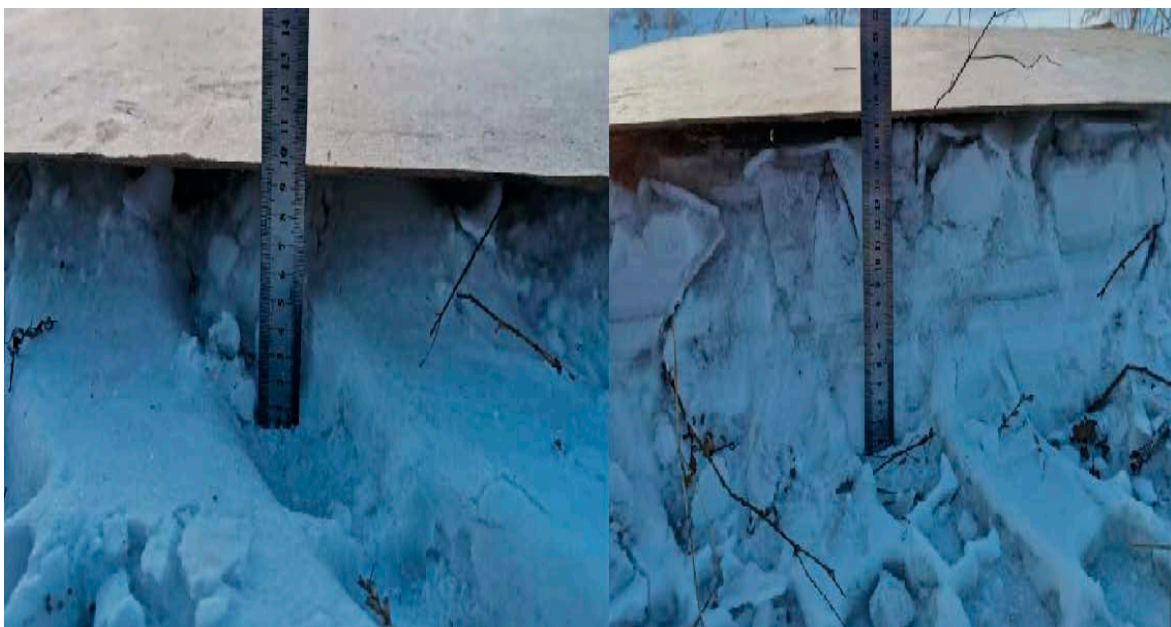
Рисунок 5 – Замеры глубины и ширины колеи после прохода экспериментального и серийного автомобилей КАМАЗ-43501
