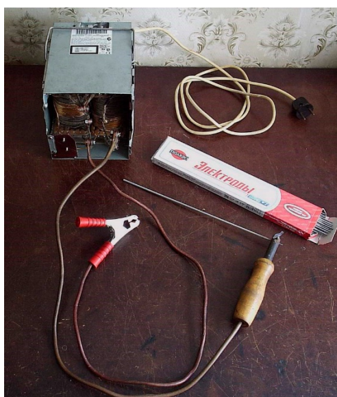
Рисунок 3 – Внешний вид сварочного аппарата на базе трансформатора ТСА-270
