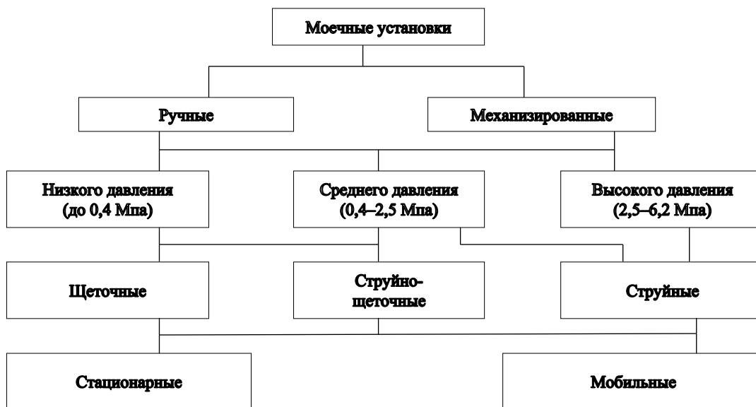
Рисунок 1 – Классификация автомобильных моечных установок
