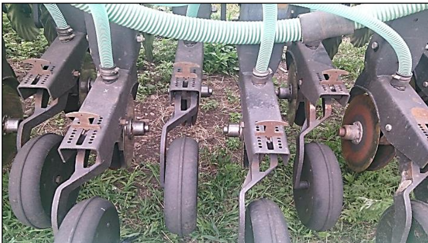
Рис.3.-Сошниковый брус с поводками сошников и прикатывающими колесами ПК «Томь – 12»
