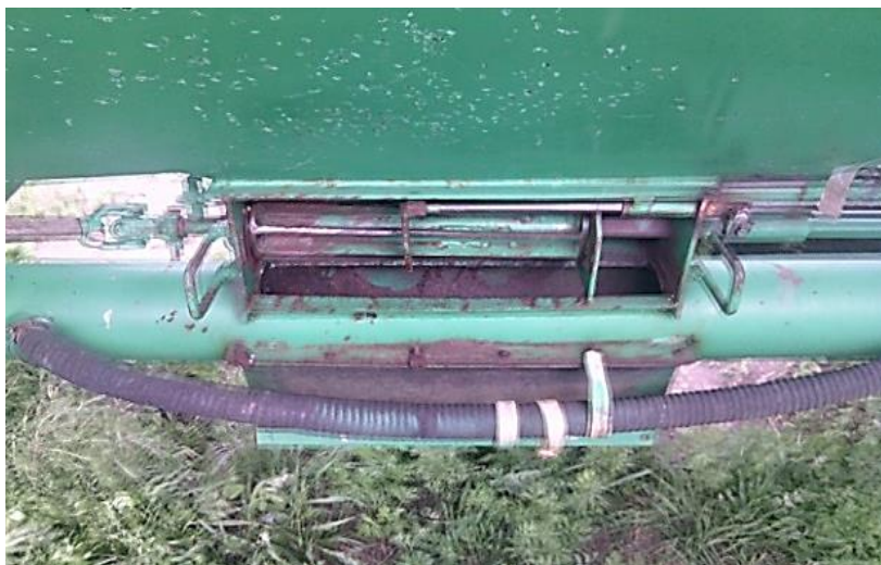
Рис.4. Высевающие катушки ПК «Томь – 12»
