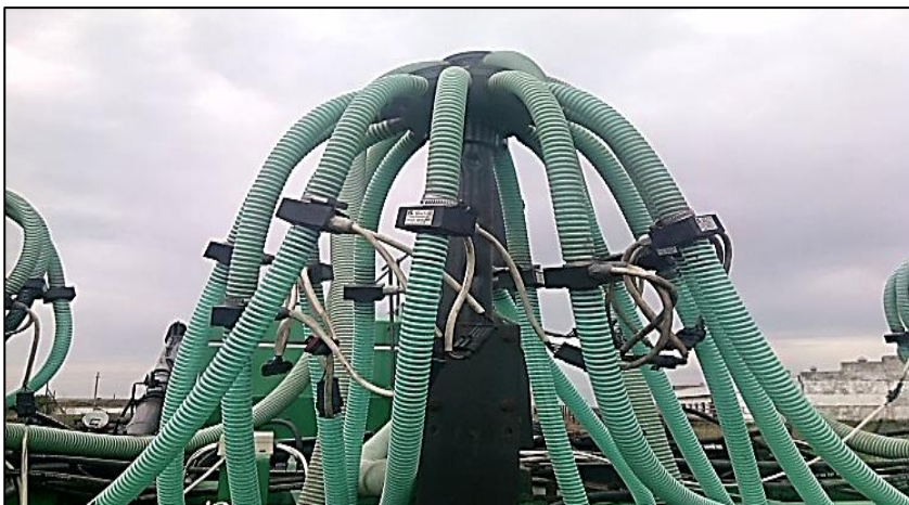
Рис.2.Автоматическая система контроля забивание каждого сошника ПК «Томь – 12»
