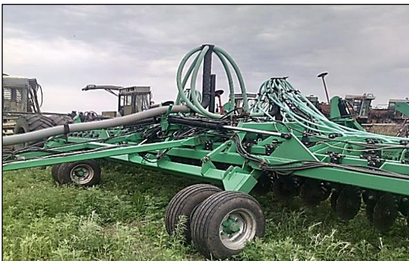
Рис.5. Сошниковый брус ПК «Томь – 12»
