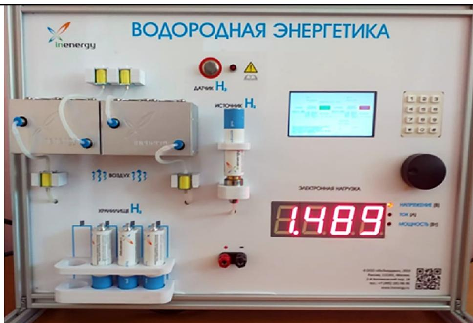
**Рисунок 1 – Внешний вид стенда «Водородная энергетика» Energy при определении значения напряжения на первой батарее топливного элемента**
