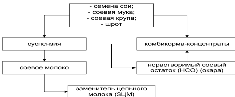
Рисунок 1 – Обобщенная схема производства соевых белковых кормов на основе соевого сырья
