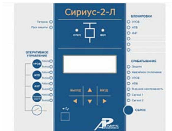
Рисунок 2 – Микропроцессорный блок "Сириус-2-ДЗЛ-01"
