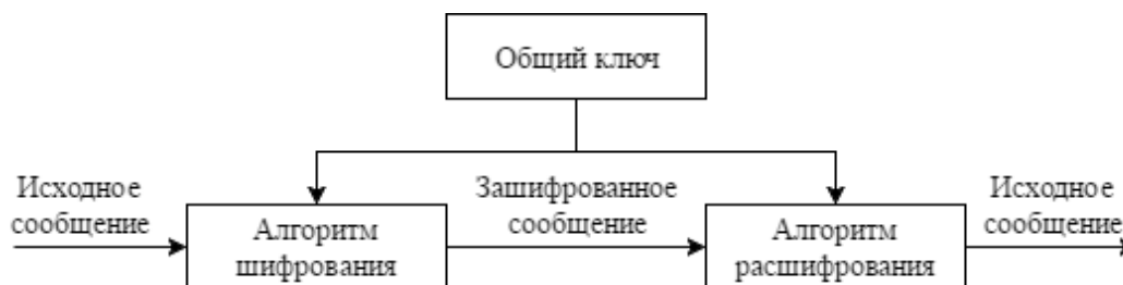
Рисунок 2 – Схема симметричного алгоритма шифрования
