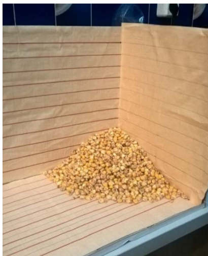
Рисунок 2 – Методика определения естественного угла откоса
