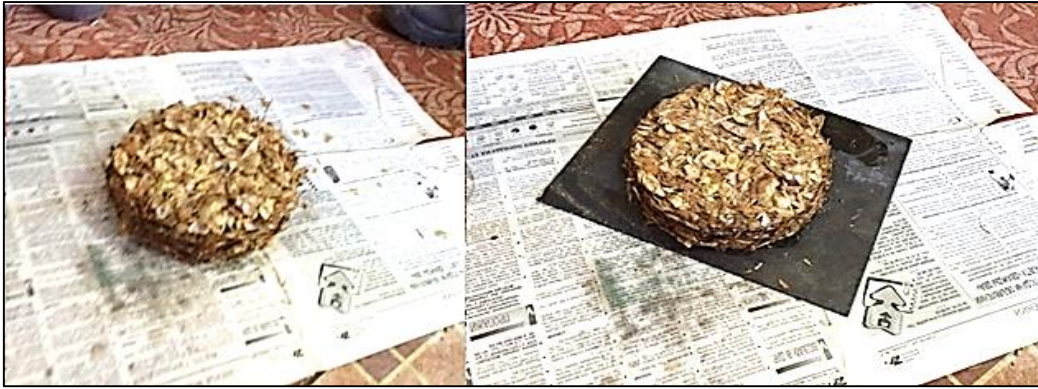
Рис. 4. Внешний вид соевой половы (стебельно-бобовая часть) после прессования при влажности 14,7 % и усилии 3,5 тс ( P_{уд} = 20,08 \text{ кгс/см}^2 )
