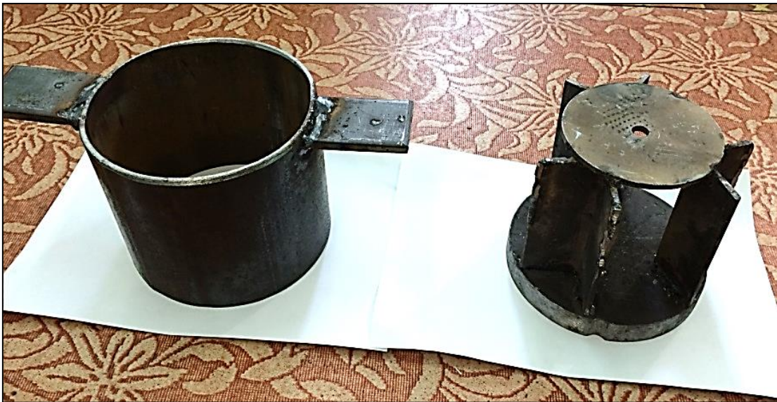
Рис. 2. пресс-форма с прессующей шайбой
