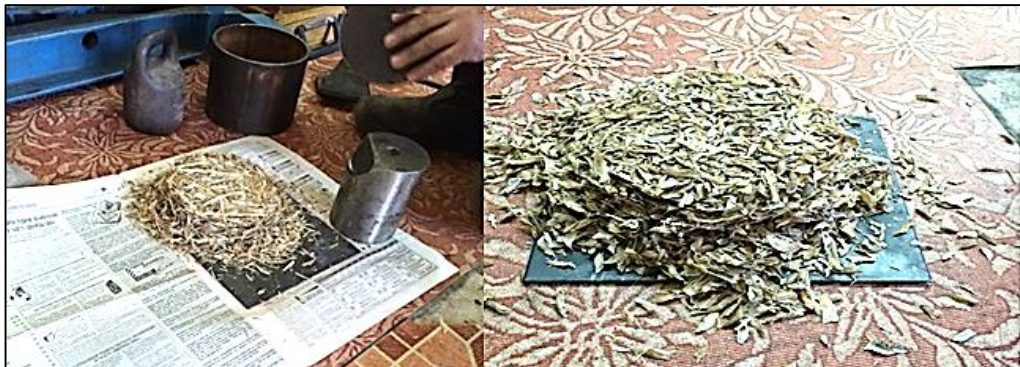
Рис. 3. Внешний вид соевой половы после прессования с усилием 2 тс ( P_{уд} = 11,47 \text{ кгс/см}^2 )
