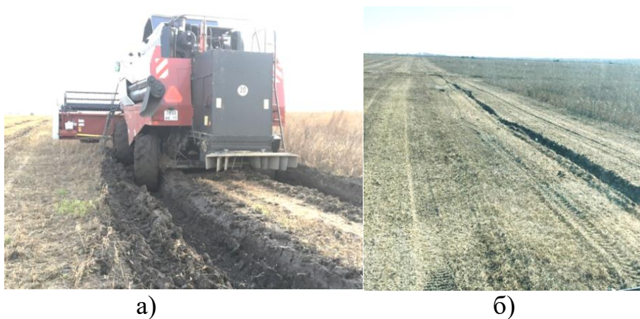
Рисунок 1 – Колея после прохода: а) колёсного, б) гусеничного комбайнов
