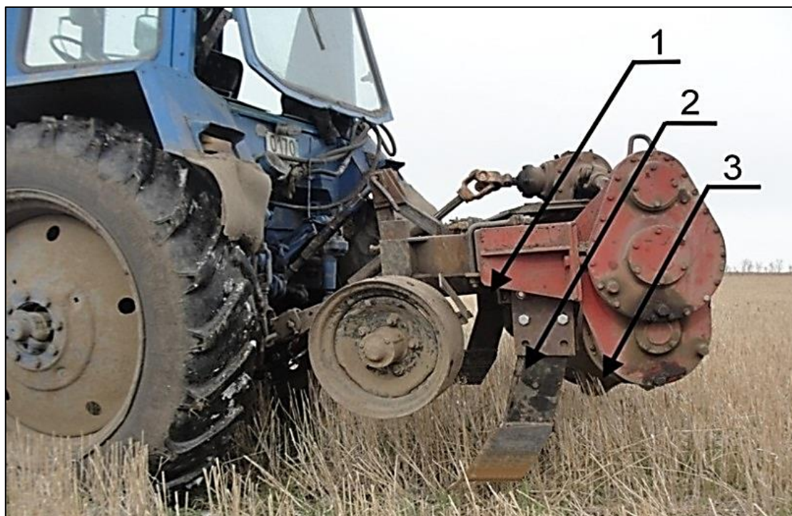
Рис.1. Экспериментальный образец модернизированного роторного плуга: 1, 2 – почвоуглубители; 3 – ротор.
