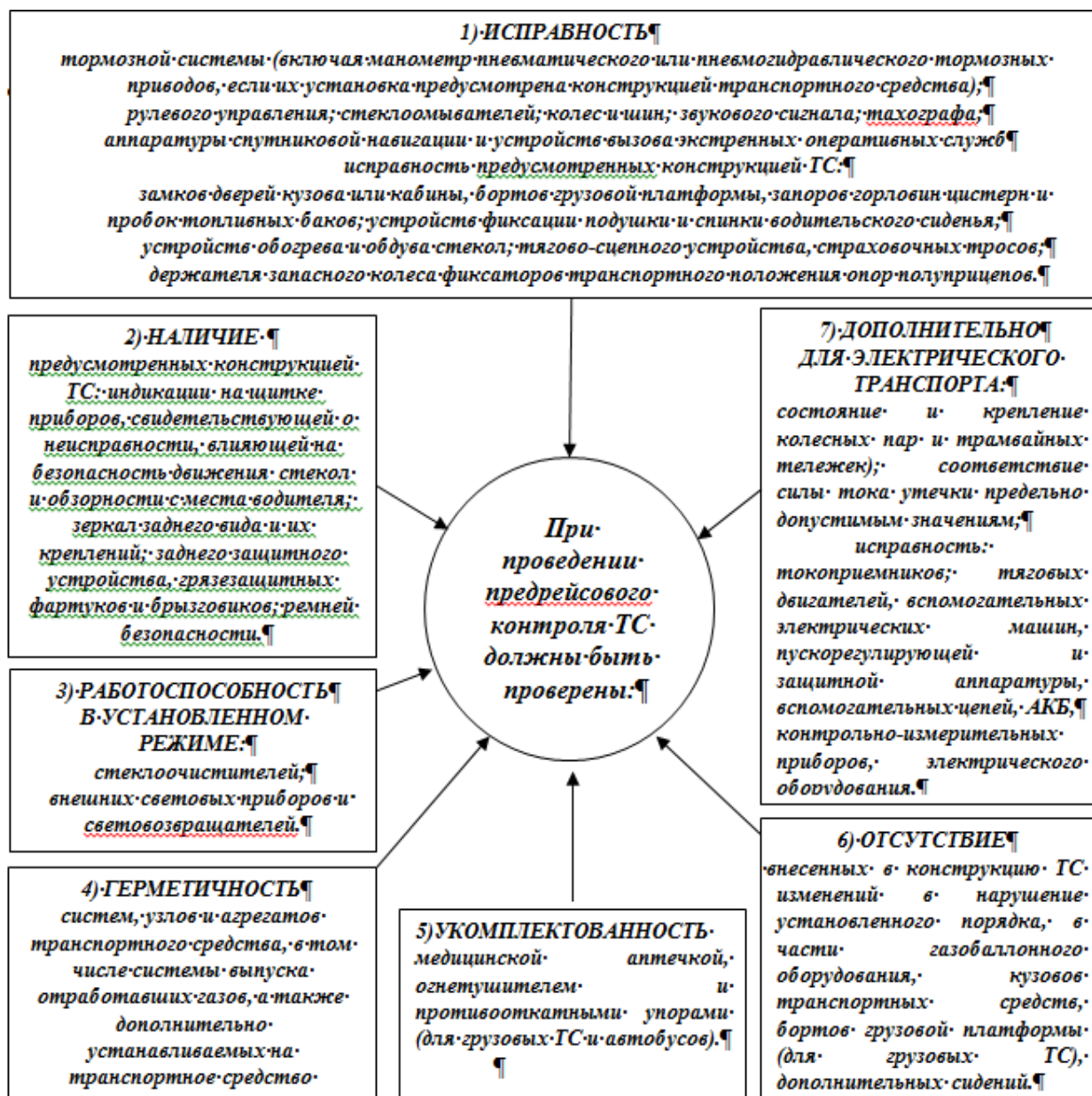
Рис.1. Методика проведения предрейсового технического осмотра ТС в соответствии с Приказом Министерства транспорта РФ № 141 [3]
