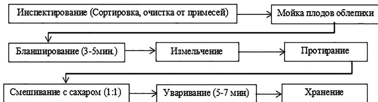
Рисунок 1 – Схема приготовления пюре из плодов облепихи
