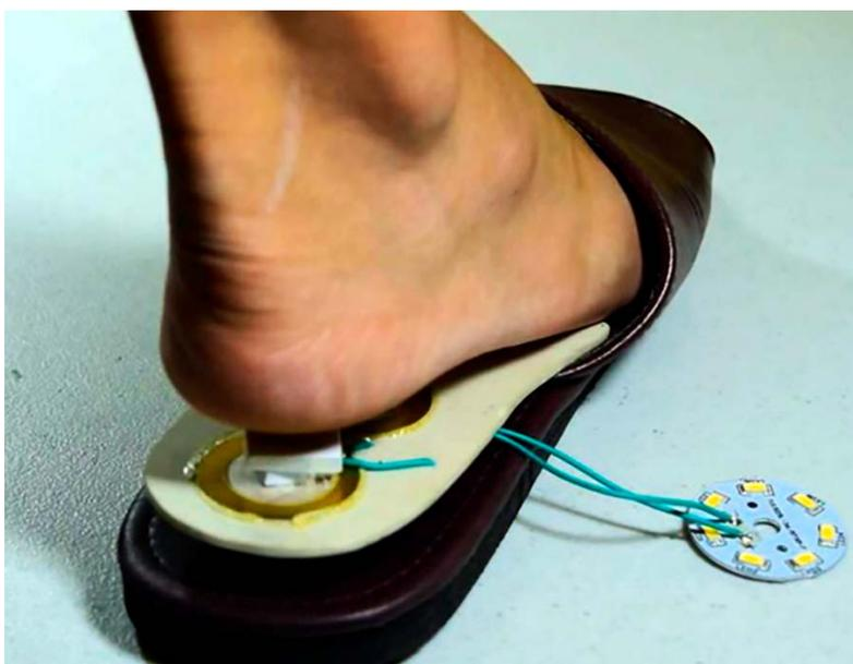
**Рисунок 4 – Пьезоэлектрическая генерация внутри каблука обуви**
