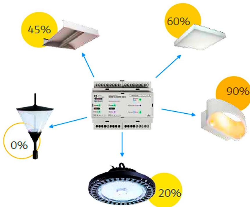
**Рисунок 2 – Адресный тип управления протоколом DALI**
