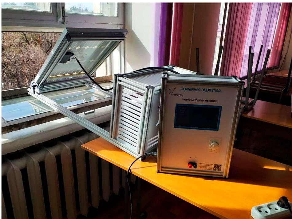
Рисунок 2 – Определение вольт-амперных характеристик солнечных панелей на стенде «Солнечная энергетика»
