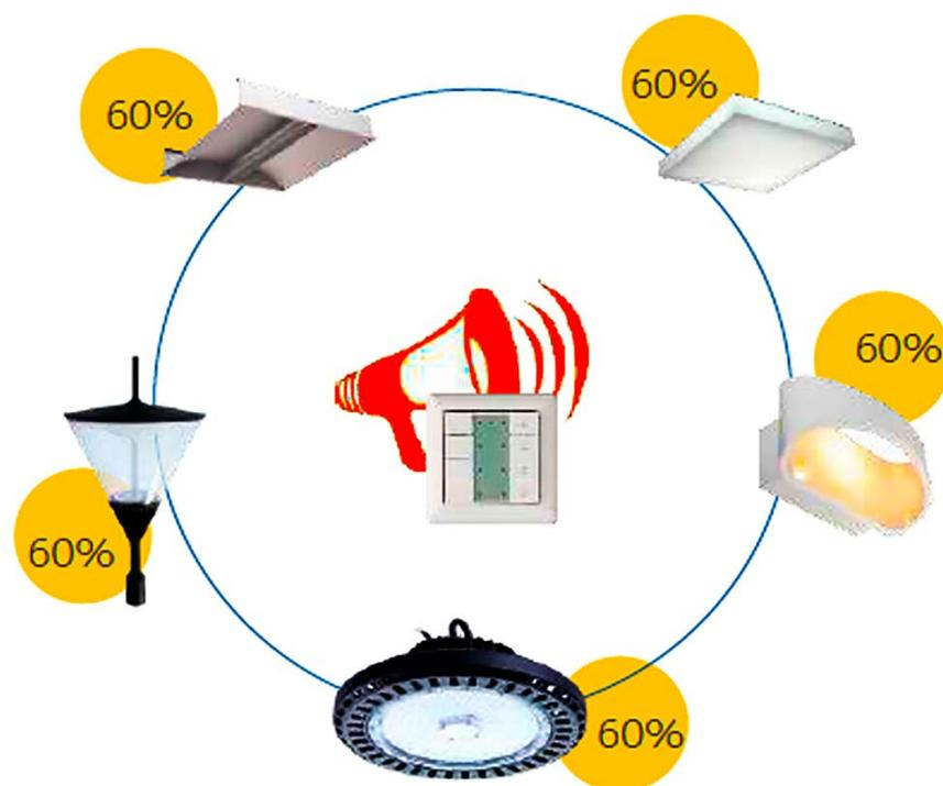
**Рисунок 1 – Широковещательный тип управления протоколом DALI**
