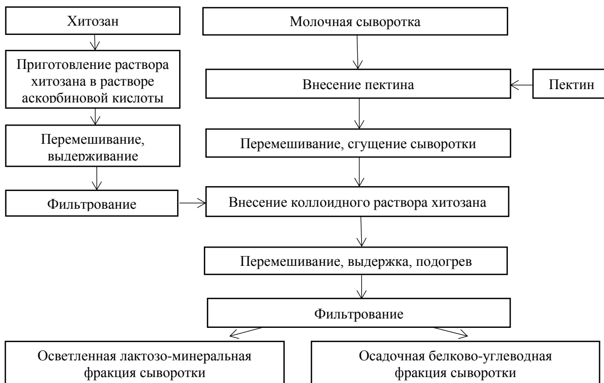
Рис. 1. Технологическая схема фракционирования сыворотки
