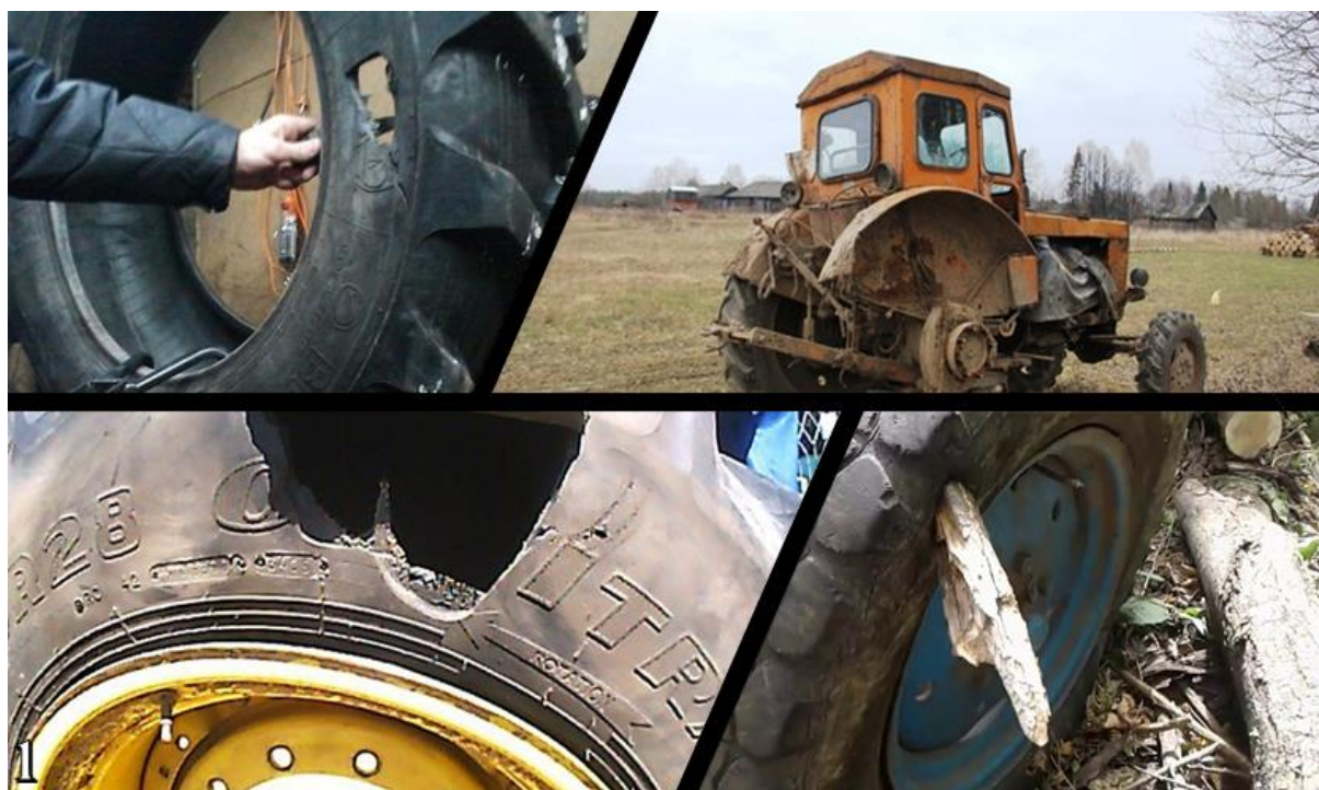
Рис. 1. Виды повреждений колёсного движителя в движении
