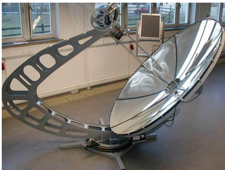
Рис. 3. Конструкция двигателя Стирлинга с использованием концентратора
