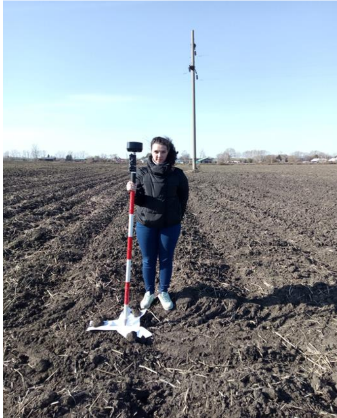
Рис. 6. Привязка при помощи опознавательных знаков
