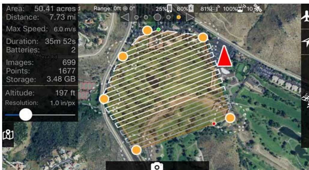
Рис. 4. Определение времени полёта, количества маршрутов и количества аккумуляторов в программном обеспечении «Map pilot»
