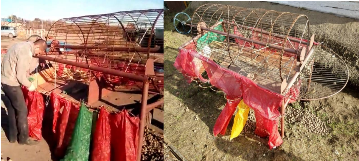
Рис. 3. Производственные испытания изготовленной картофелесортировочной машины
