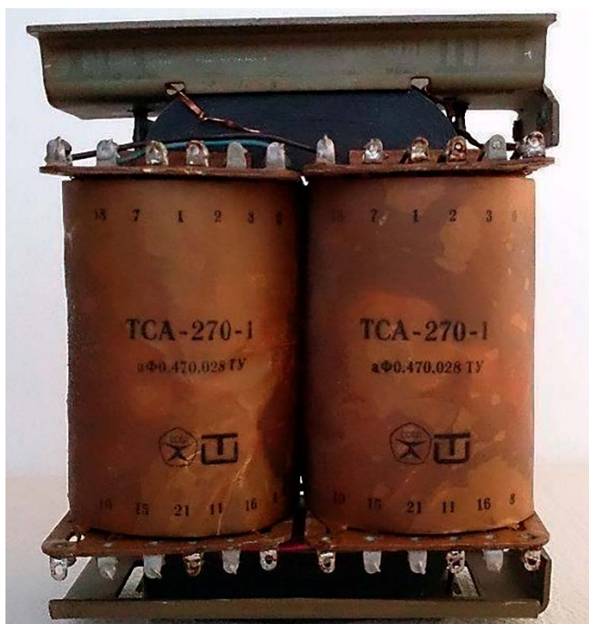
Рисунок 1 – Внешний вид трансформатора ТСА-270
