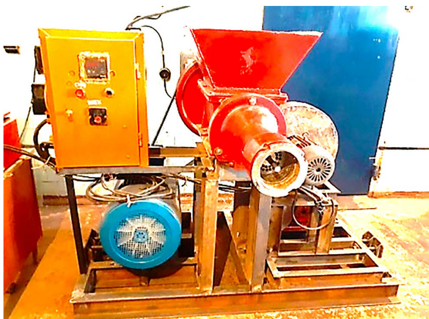
Рисунок 2 – Опытный образец гранулятора шнекового типа
