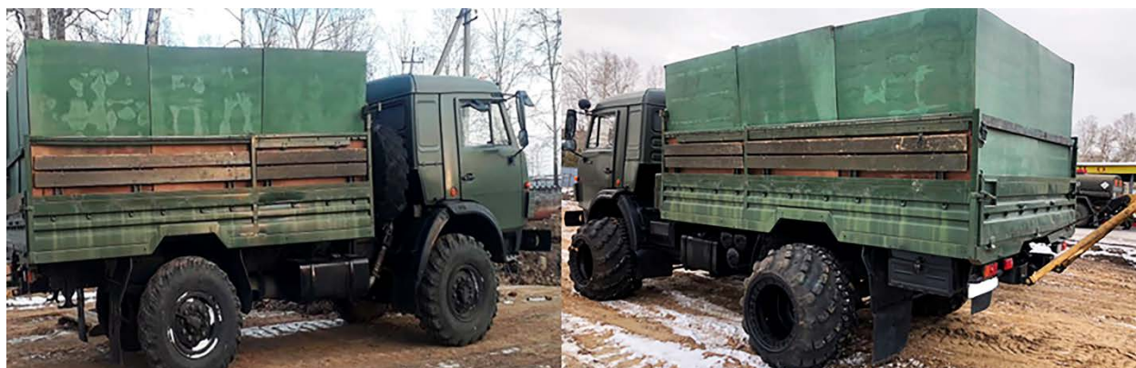
Рисунок 2 – Серийный автомобиль КамАЗ-4350 с колесной формулой 4К4 (справа) и экспериментальный автомобиль КамАЗ-4350 с догружающим модулем для грузового автомобиля (слева)
