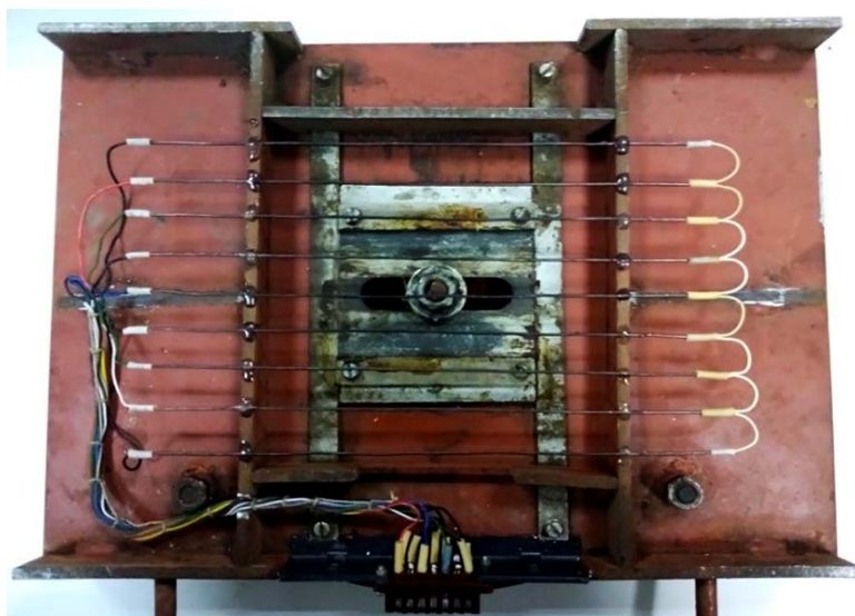
Рисунок 2 – Диагностическая площадка для определения внутренних напряжений в автомобильных шинах
