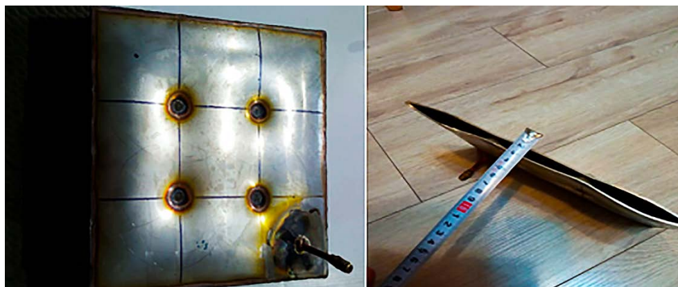
Рисунок 3 – Заготовка для практического подтверждения расчётных параметров при планировании панельного теплообменника
