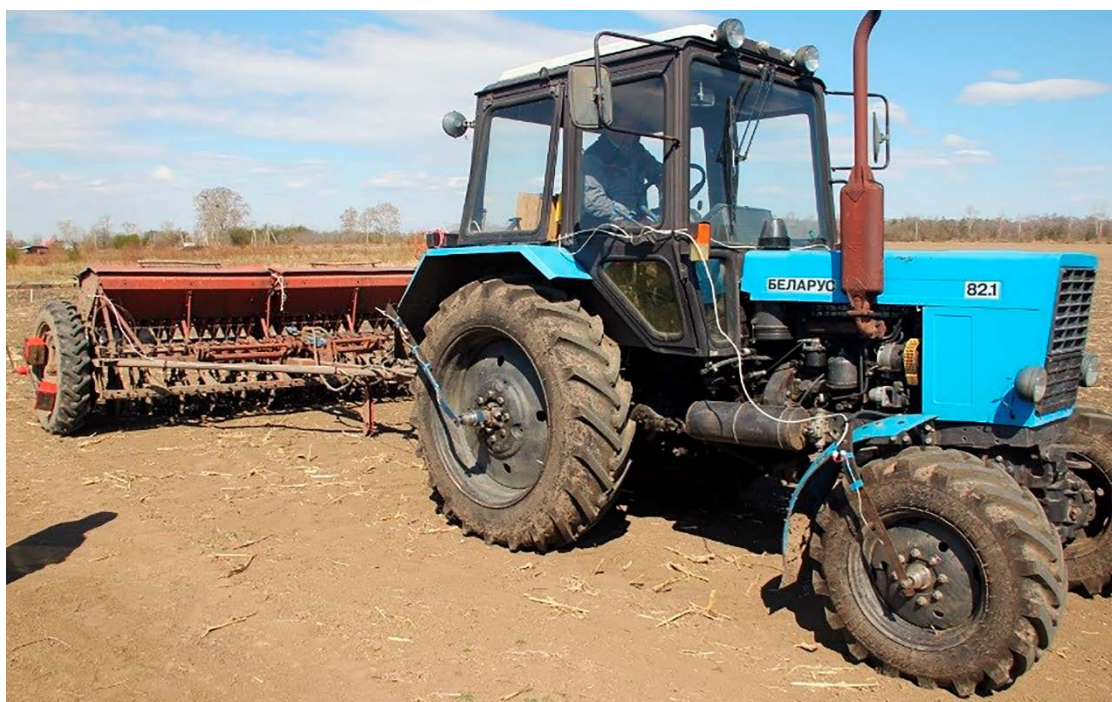
Рисунок 3 – Экспериментальный машинно-тракторный посевной агрегат
