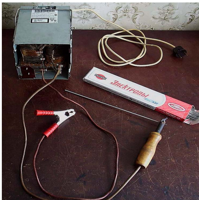
Рисунок 2 – Внешний вид сварочного аппарата на базе трансформатора ТСА-270
