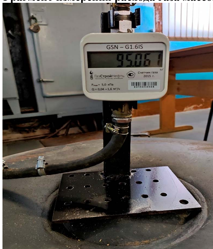
Рисунок 4 – Фрагмент измерения расхода газа объёмным методом
