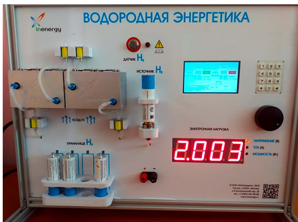
Рисунок 2 – Устройство стенда «Водородная энергетика» (Energy) для определения значений напряжения при заданной нагрузке
