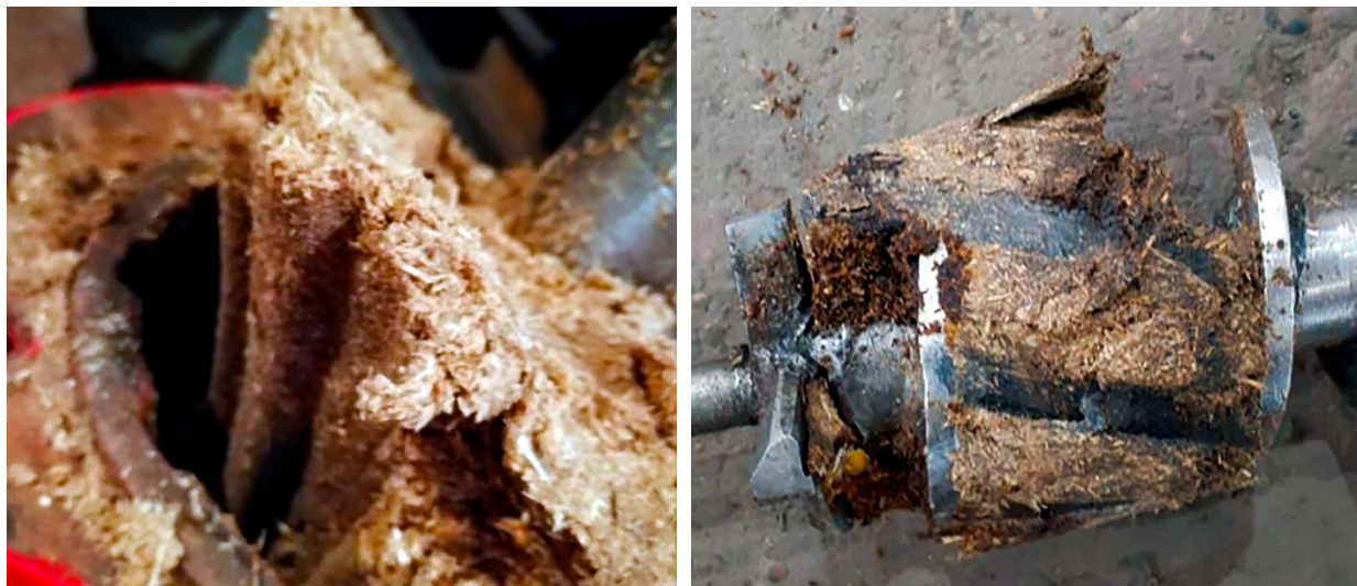
Рисунок 3 – Прессование соевого вороха в стволе гранулятора (слева) и в витках прессующего шнека (справа)
