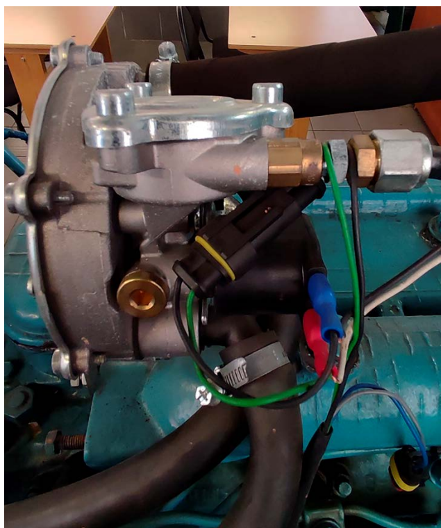
Рисунок 2 – Редуктор испаритель газа
