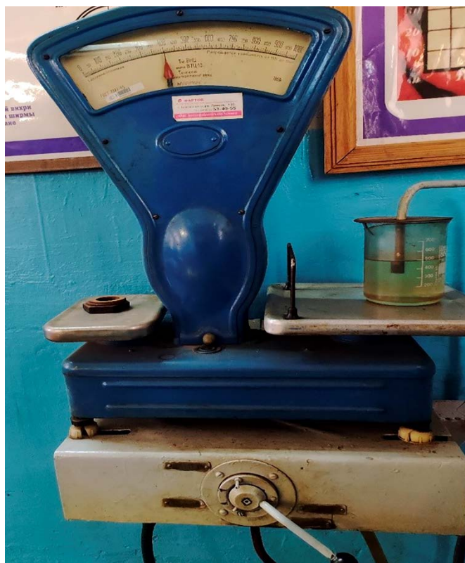
Рисунок 5 – Фрагмент измерения расхода дизельного топлива массовым методом
