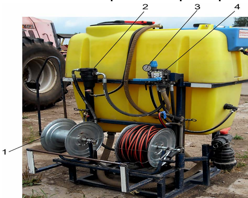
1 – барабаны для намотки шлангов; 2 – фильтр тонкой очистки; 3 – манометр; 4 – регулятор-распределитель
