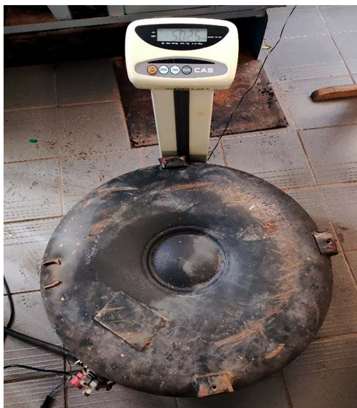
Рисунок 3 – Фрагмент измерения расхода газа массовым методом
