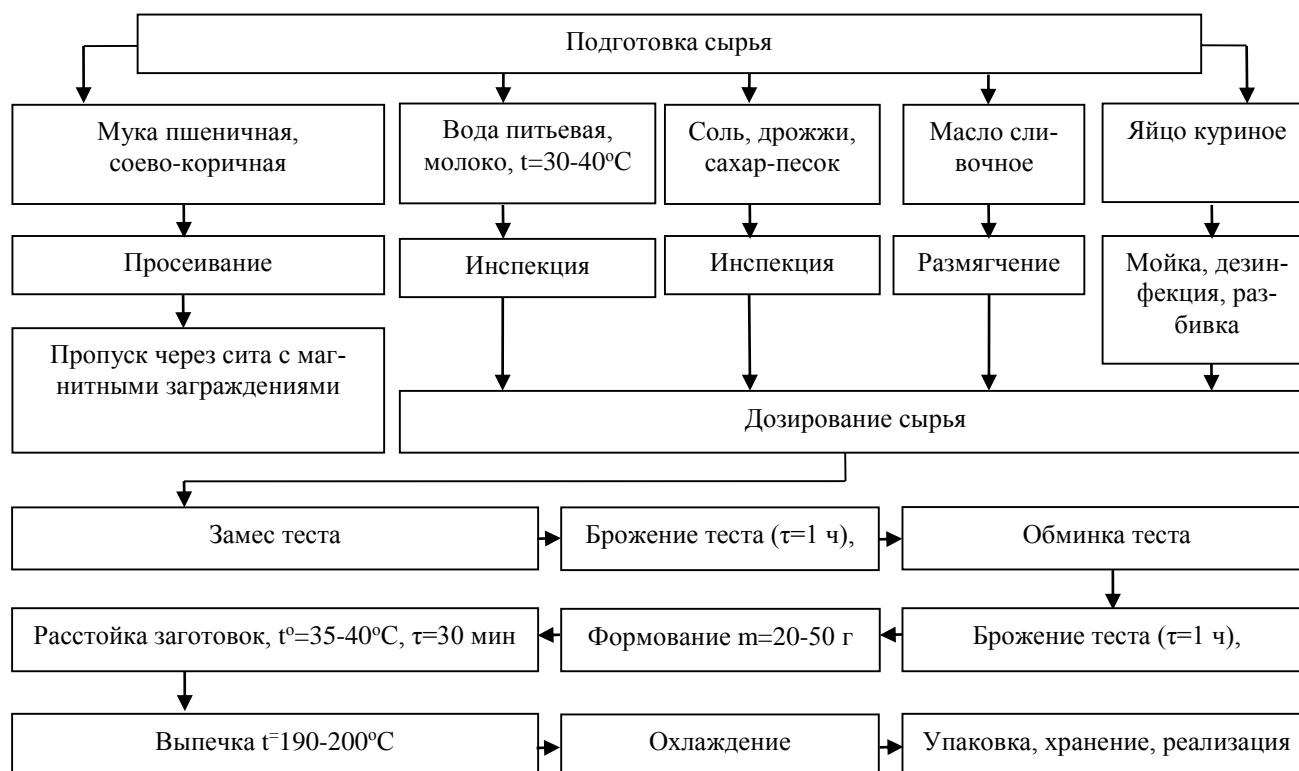
Рис. 1. Технологическая схема производства булочек с соево-коричной мукой
