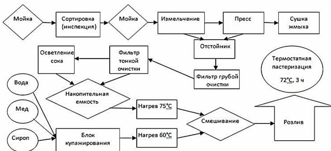
Рис. 1. Принципиальная схема получения купажированного сока с добавлением меда
