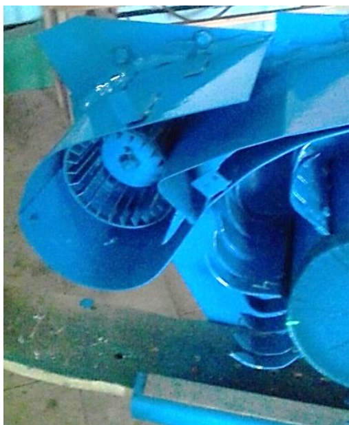
Рис. 2. Установка дополнительного вентилятора
