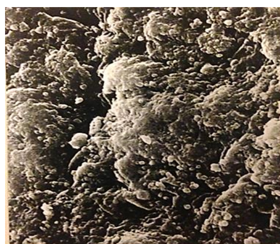
Рис.2. Скан-электронограмма внешней поверхности углеродминерального сорбента марки СУМС-1 с адсорбированными на ней колониями стафилококка (ув.4000). Количество-171375 колоний.
