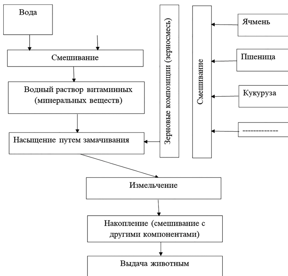
Рисунок 2 – Технологическая схема получения кормового продукта на основе зернового сырья
