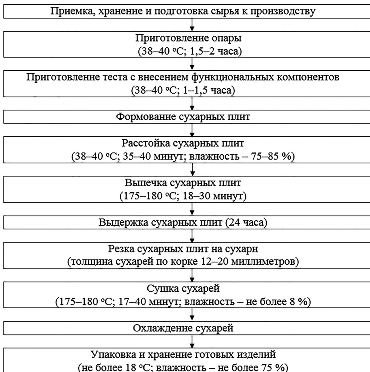
Рисунок 1 – Технологическая схема производства сдобных сухарей с функциональными добавками
