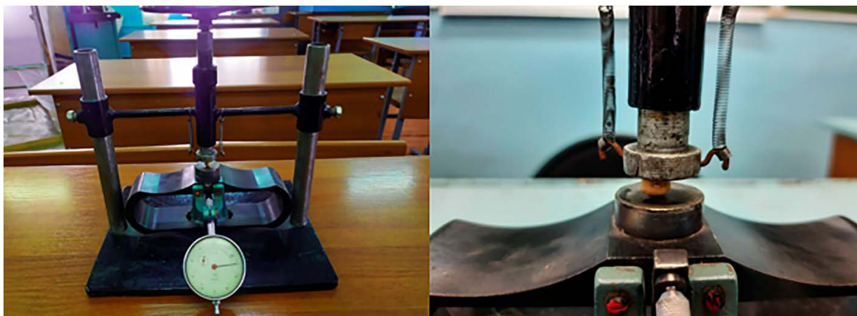
Рисунок 4 – Тензометрическая установка для изучения механических свойств сельскохозяйственных культур
