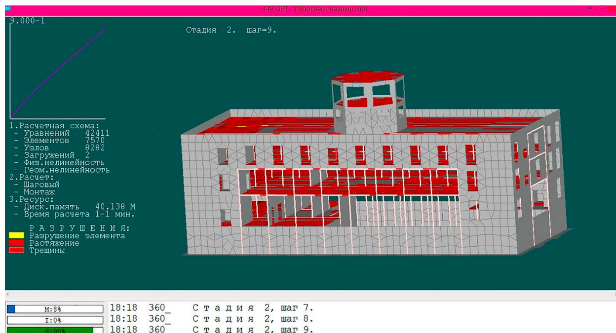
Рисунок 2 – Расчёт здания на прогрессирующее разрушение
